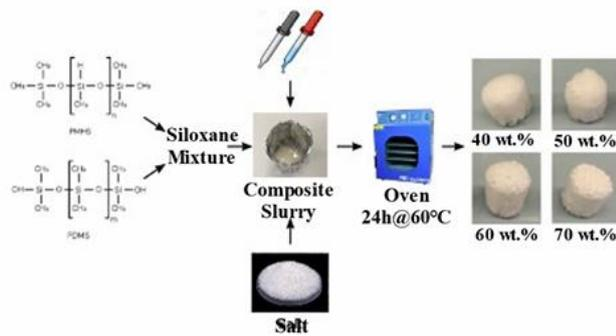
Figura 15. Rappresentazione schematica schiumatura [27].
