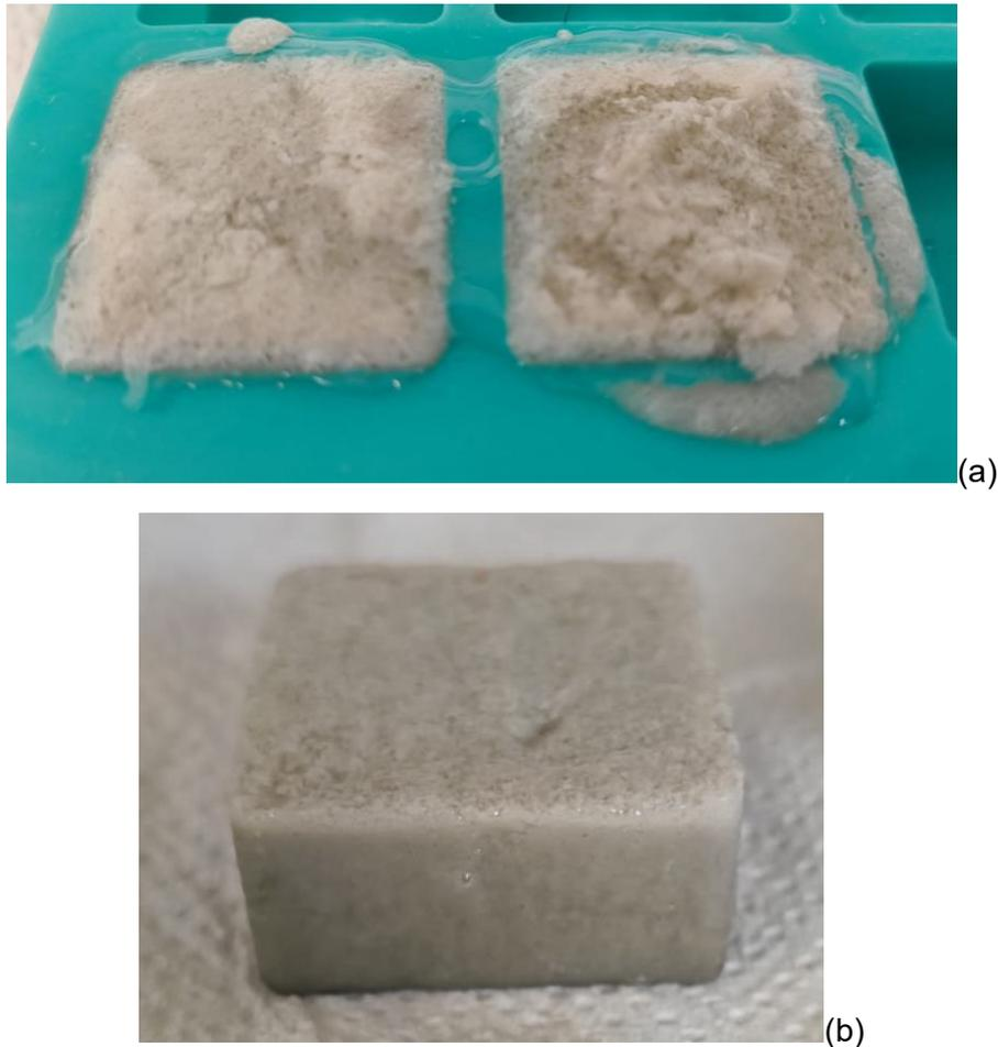
Figura 36. Dettaglio del campione PC1ACaCl<sub>2</sub>\_09 prima (a) e dopo (b) essere stato rimosso dallo stampo.
