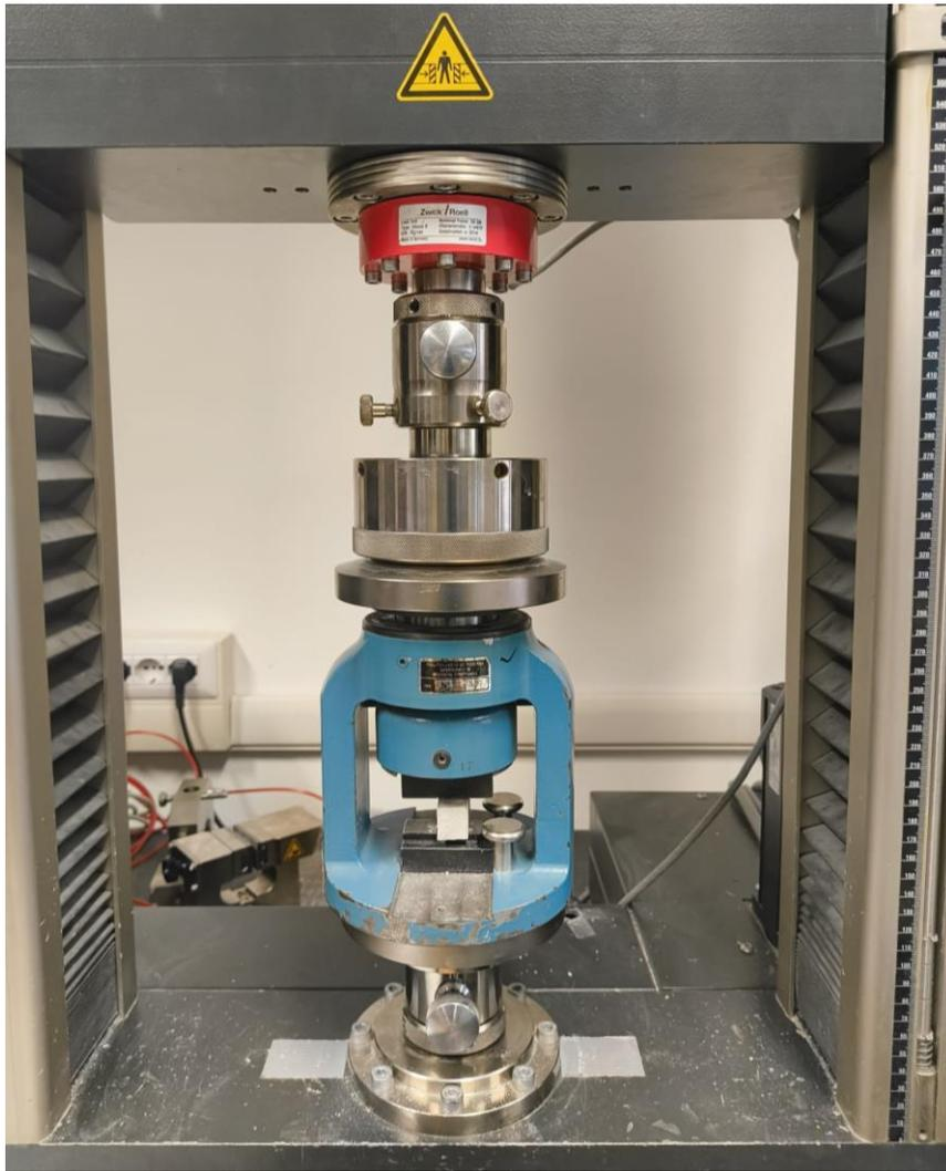
Figura 43. Immagine apparato per prova di compressione.
