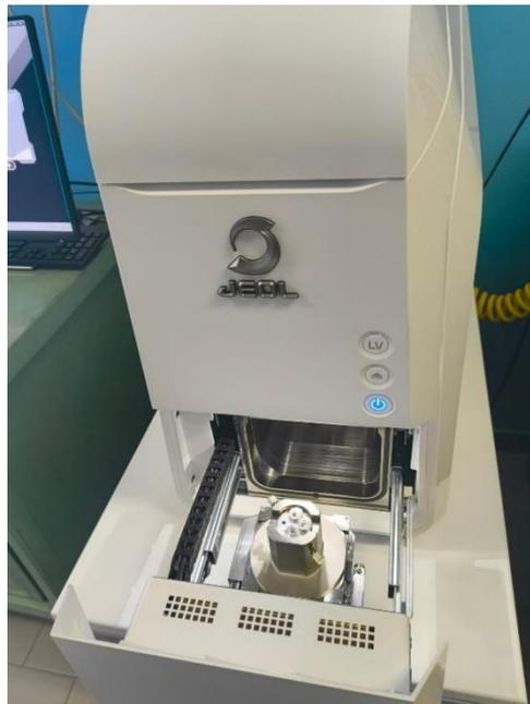
Figura 69. Immagine apparecchiatura SEM.
