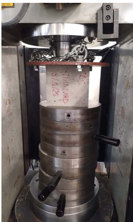
Figura 25: pressa idraulica automatica per prove di resistenza sul calcestruzzo
