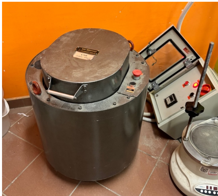
Figura 9: Mulino a disco vibrante
