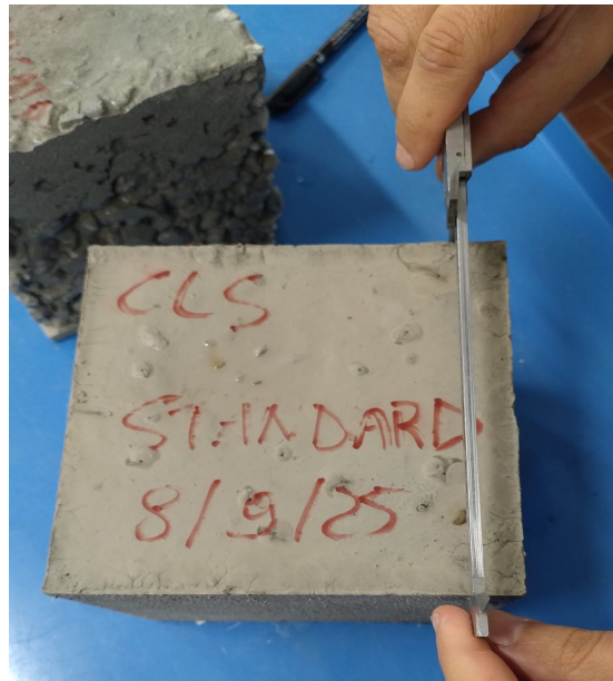
Figura 27: Misurazione lato del provino cubico di calcestruzzo
