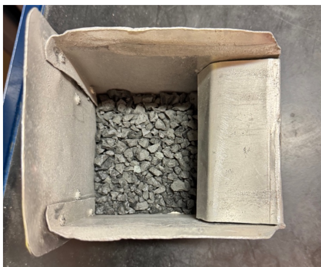
Figura 8: scoria ridotta in frammenti di dimensione ridotte rispetto all'originale
