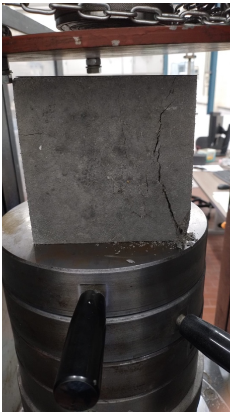
Figura 26: Provino di calcestruzzo cubico subito dopo il raggiungimento del carico massimo di rottura, che ha causato una fessurazione diagonale tipica della compressione.
