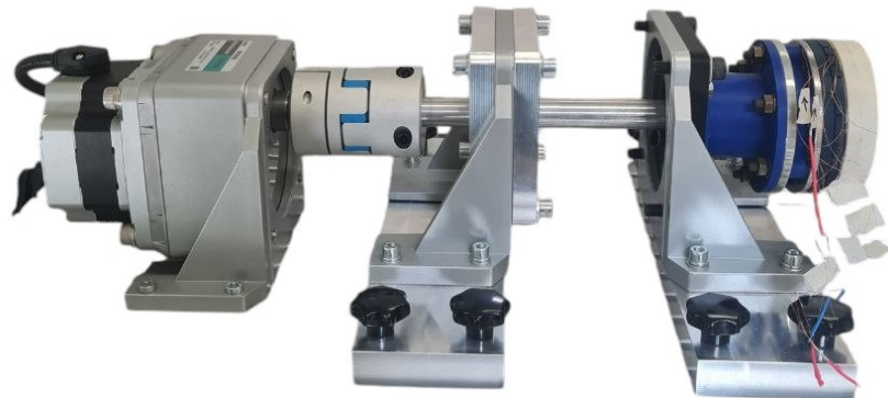
Figura 9.1: Configurazione reversed impiegata per le prove elettriche
