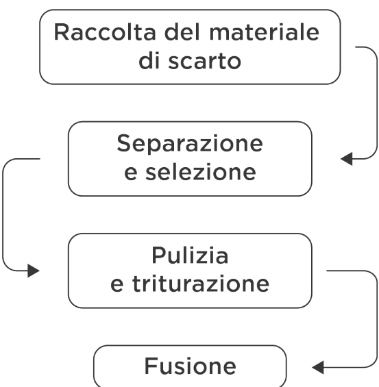
Figura 92 - Schema del processo di riciclo del titanio
