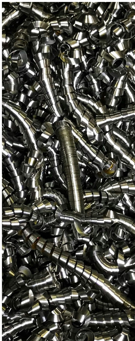
Figura 104 - Trucioli da lavorazione di titanio
