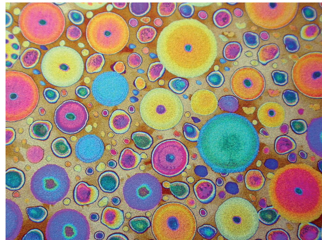
Figura 67 - Ossidazione anodica del titanio
