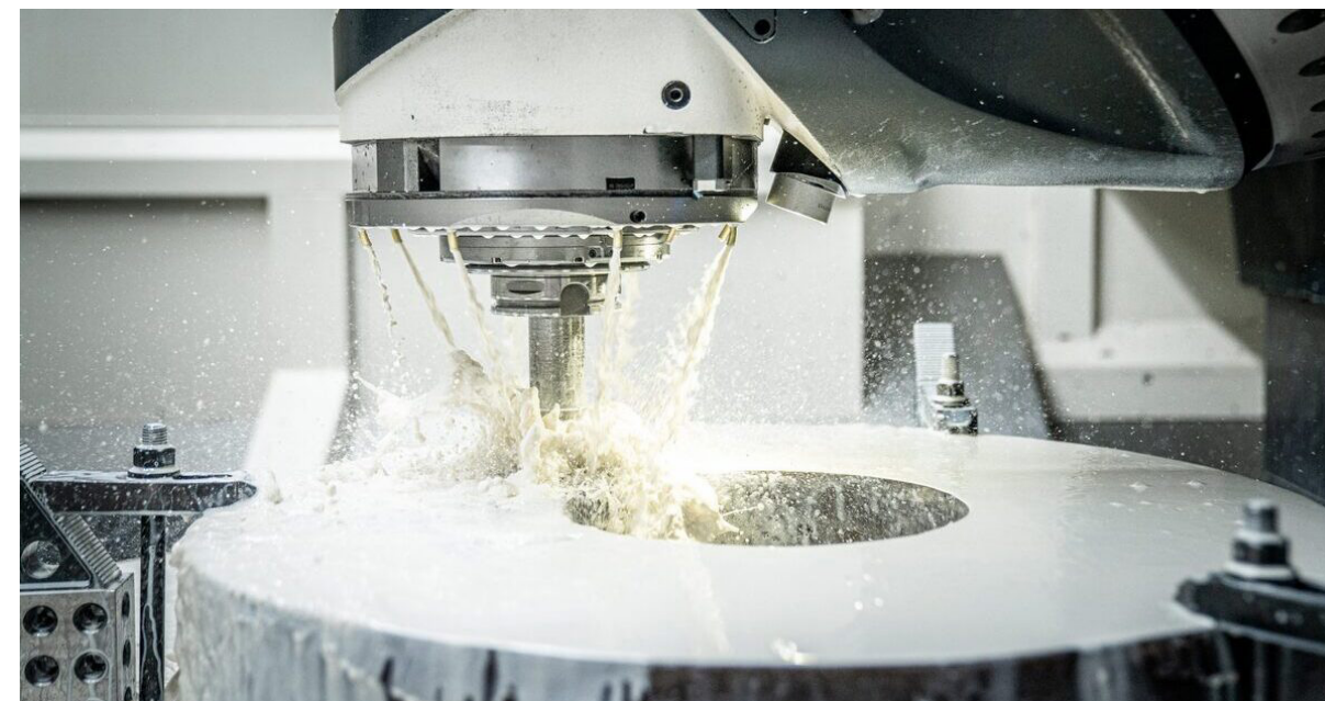
Figura 89 - Lavorazione del titanio con CNC
