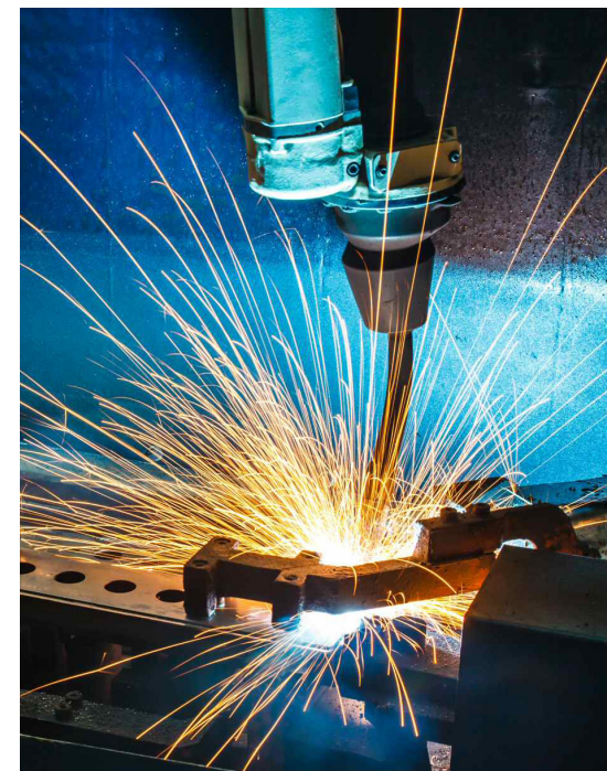
Figura 13 - Saldatura di lamiera
