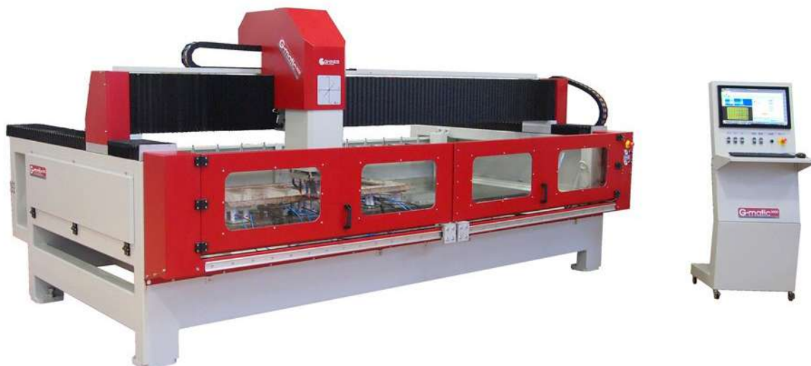
A sinistra centro di lavoro cnc, a destra computer per inserimento dei parametri di lavorazione
