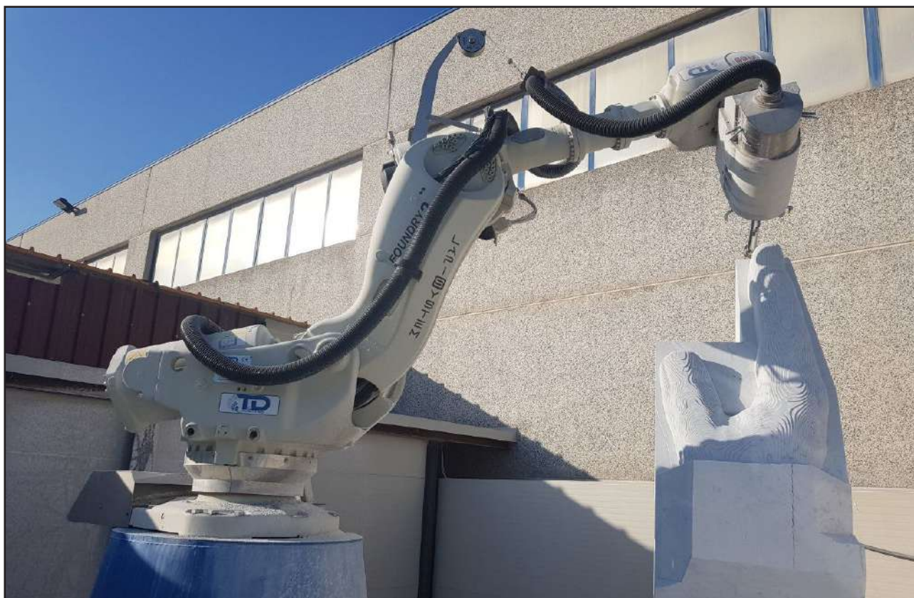
Il robot equipaggiato con una fresa diamantata modella la scultura su comando di un computer, utilizzando come riferimento un modello 3D in formato digitale
