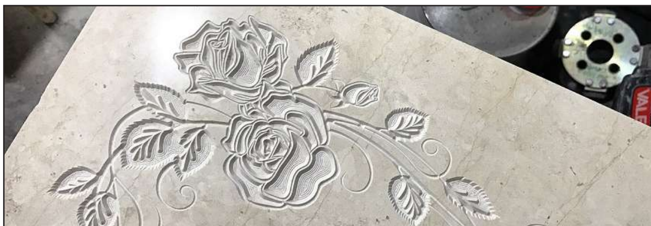
Rosa a rilievo relizzata con tecnologia waterjet
