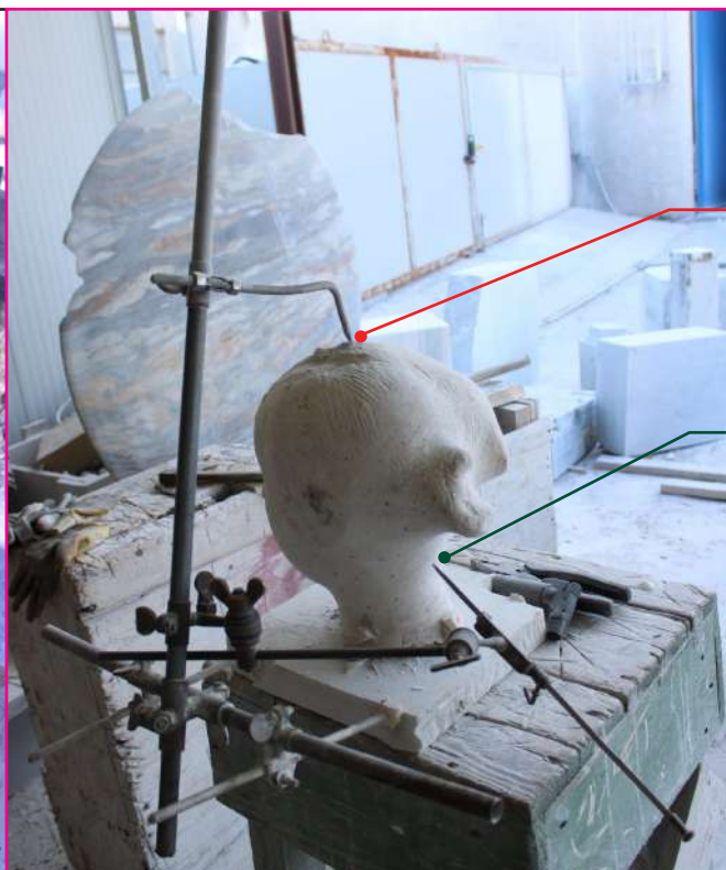
La modellazione avviene tramite "macchinetta", un dispositivo per riportare una forma da un modello in gesso ad un blocco da lavorare. La "macchinetta" viene fissata in un punto A del modello e regolato il braccio si irrigidisce la struttura su un punto B. Lo strumento viene poi spostato sul blocco da lavorare ancorandolo nel punto A' corrispondente. In questo modo il punto B' indicherà il punto preso in considerazione come riferimento. Più punti si riportano dal modello all'originale, più la copia è precisa.
