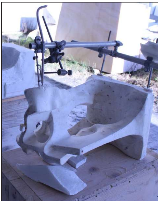
La modellazione avviene tramite "macchinetta", un dispositivo per riportare una forma da un modello in gesso ad un blocco da lavorare. La "macchinetta" viene fissata in un punto A del modello e regolato il braccio si irrigidisce la struttura su un punto B. Lo strumento viene poi spostato sul blocco da lavorare ancorandolo nel punto A' corrispondente. In questo modo il punto B' indicherà il punto preso in considerazione come riferimento. Più punti si riportano dal modello all'originale, più la copia è precisa.
