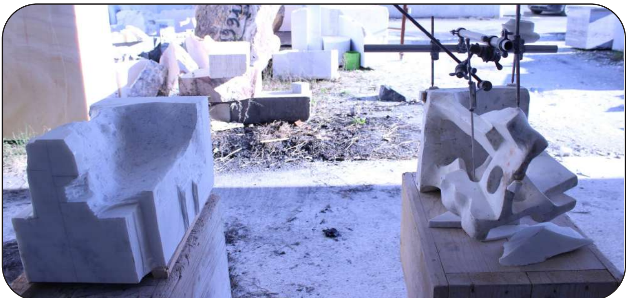
esempio di “Macchinetta” a destra è presente il modello mentre a sinistra la forma riportata nel marmo
