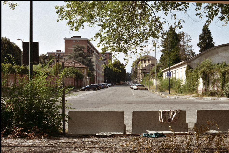
↑ Barriere New Jersey poste sull'asse di via Cimarosa davanti alla recinzione d'ingresso dell'edificio
