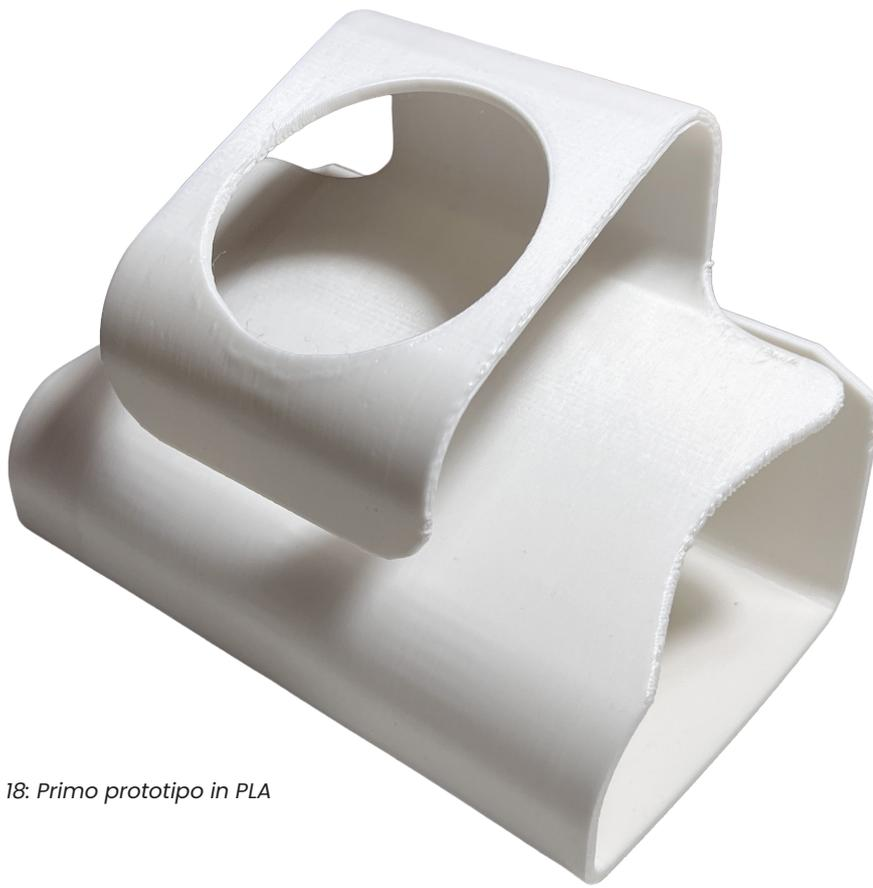
*Fig. 18: Primo prototipo in PLA*
