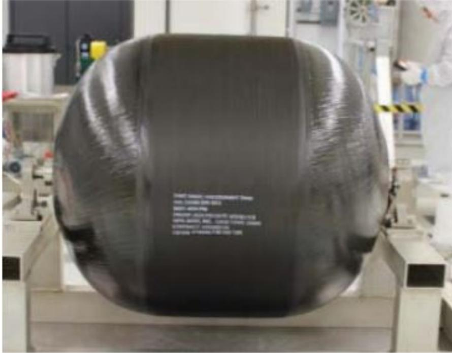
**Figura 4.11:** Fotografia raffigurante un serbatoio GDS fissato con gli appositi supporti durante una fase di test strutturale.
