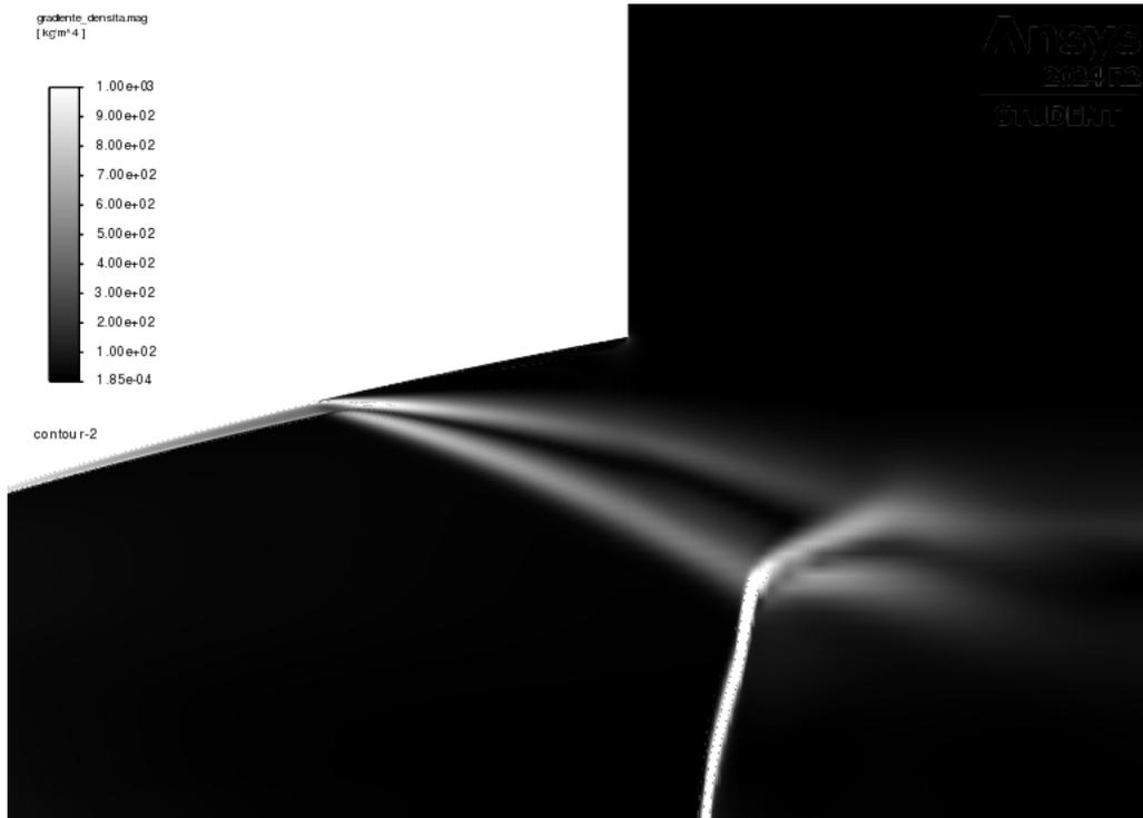
Figura 2.26: Campo del gradiente di densità nell'intorno del punto triplo
