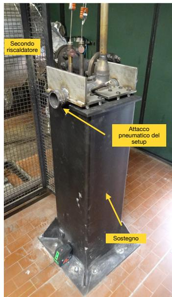
Figura 2.17: Dettaglio sull'uscita dal secondo riscaldatore, sostegno del tubo di ingresso e attacco del setup.
