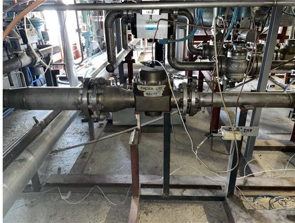
(a) Trasduttore  $P_{PIL}$  montato sul corpo dell'IMF.
