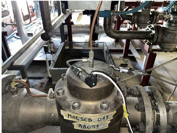
(b) Dettaglio del trasduttore  $P_{PIL}$  e della camera di riferimento.
