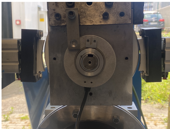
Figura 5.23: Ceppi e ruota verniciati per ottenere un'emissività nota alla termocamera
