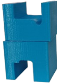
Figura 5.2: Blocchetti supporto per cella di carico
