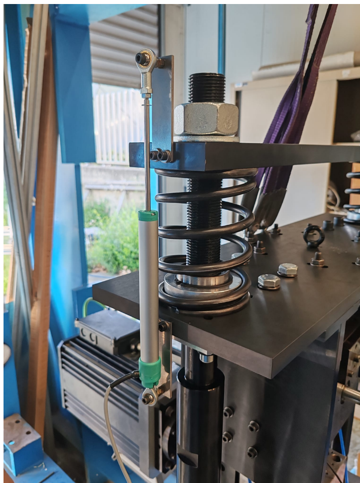
Figura 4.12: Particolare del potenziometro montato lateralmente al banco
