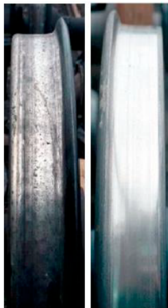
Figura 2.1: Effetto dell'uso di ceppi in ghisa e in composito su tavole di ruote ferroviarie
