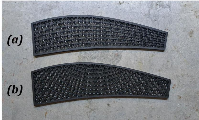
Figura 99 - Realizzazione dei componenti oggetto di test: (a) componente con struttura LS; (b) componente con struttura LO.
