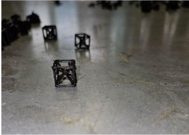
*Figura 59 - Difettosità dei provini in PA6-CF.*
