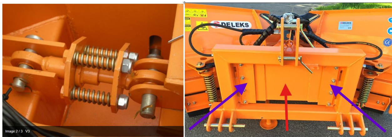
Figura 3: foto sistema di beccheggio su vomero Pelazza [4] Figura 4: foto vomero Deleks con frecce per evidenziare piastre [6]
