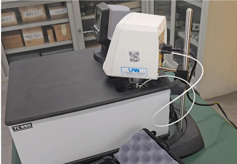
*Figura 5.3 Sonda di temperatura*
