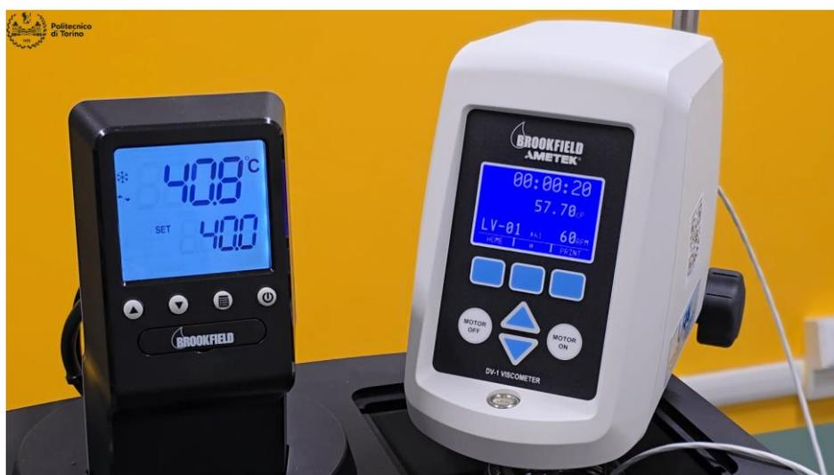
Figura 5.12 Valore di viscosità rilevato a 40°C
