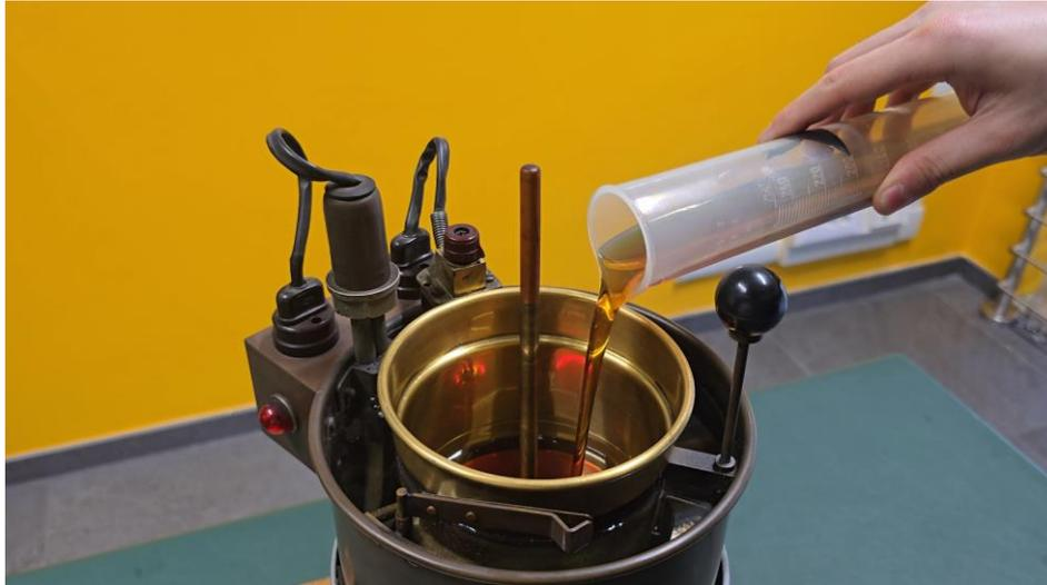
*Figura 5.16 Riempimento del serbatoio con olio*
