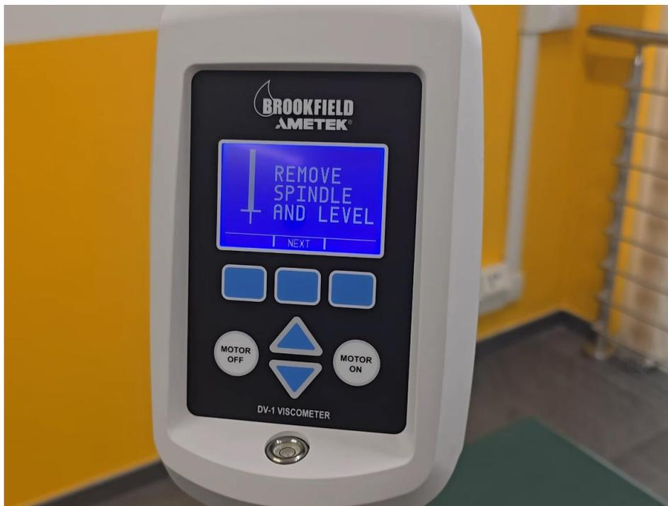
*Figura 5.2 Testa del viscosimetro rotazionale con display*
