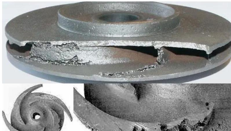
Figura 3.7 Effetto della cavitazione in una pompa
