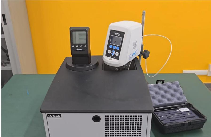
*Figura 5.1 Viscosimetro rotazionale*
