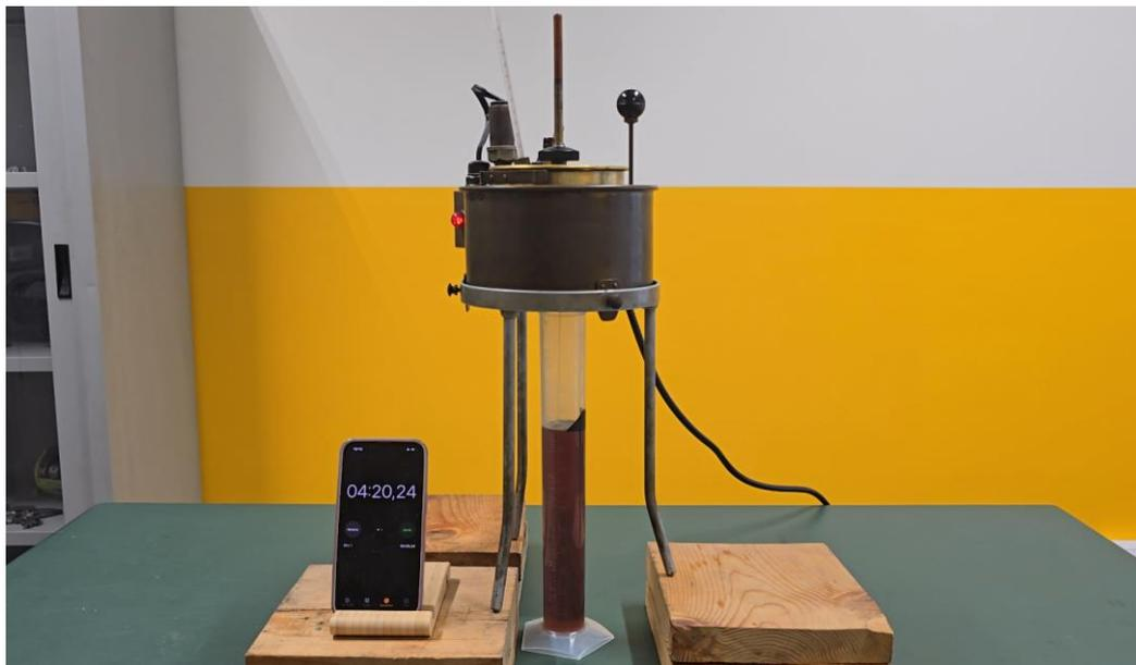
*Figura 5.18 Tempo di efflusso registrato a 60°C*
