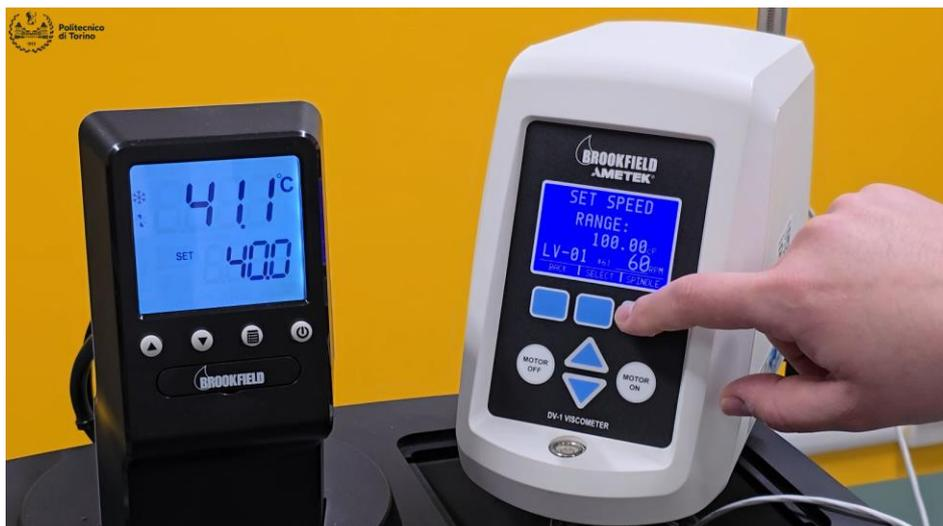
Figura 5.10 Cambio di velocità di rotazione a 40°C
