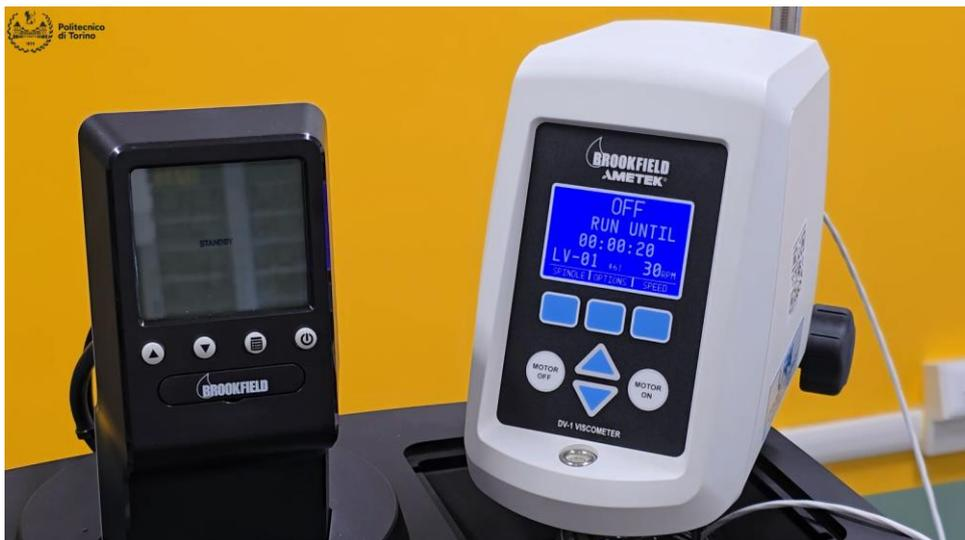
*Figura 5.6 Settaggio della durata della prova*
