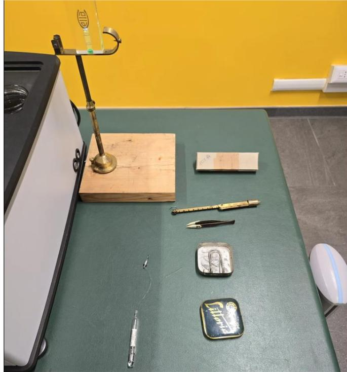
*Figura 5.21 Strumentazione utilizzata col densimetro Mohr-Westphal*
