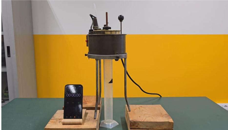
Figura 5.15 Viscosimetro Engler livellato e timer
