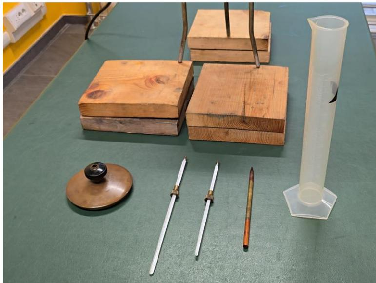
*Figura 5.17 Strumentazione utilizzata col viscosimetro Engler*
