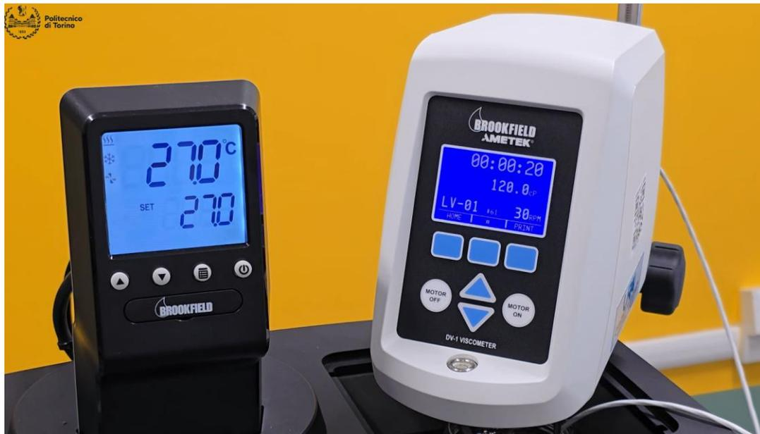
*Figura 5.7 Valore di viscosità rilevato a 27°C*
