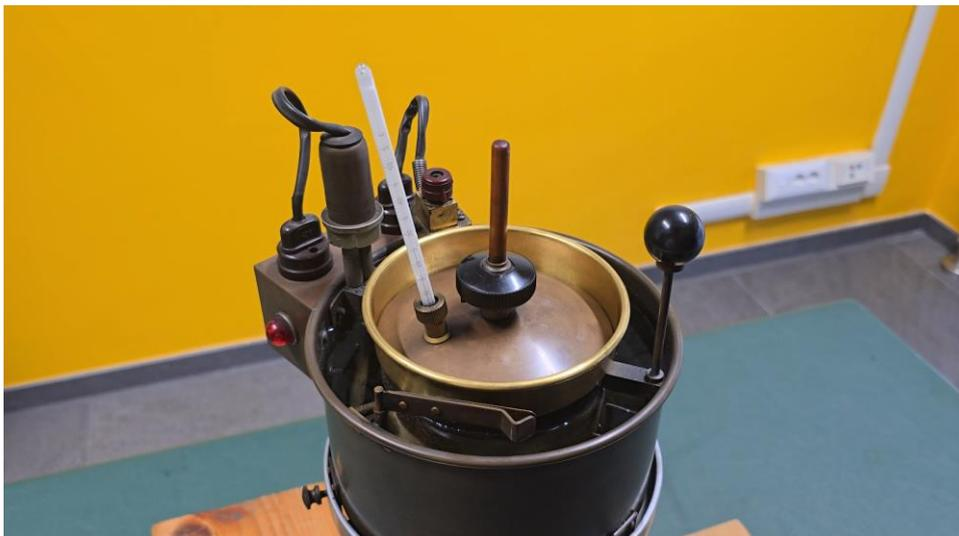
*Figura 5.14 Viscosimetro Engler*
