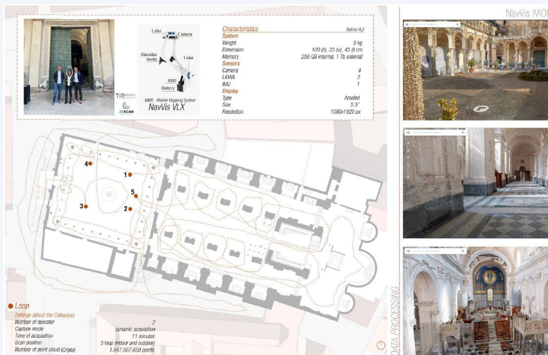
Figura 20 Mappa e percorso del rilievo eseguito attraverso l'uso di LaserScanner Dinamico
