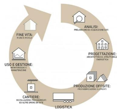
Figura 13 – Rappresentazione del processo edilizio secondo l'approccio Energiesprong. Fonte: <https://www.energiesprong.it/il-processo/>
