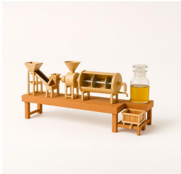
**Strumenti del fare** / Modello di frantoio a ciclo continuo, scala 1:10
