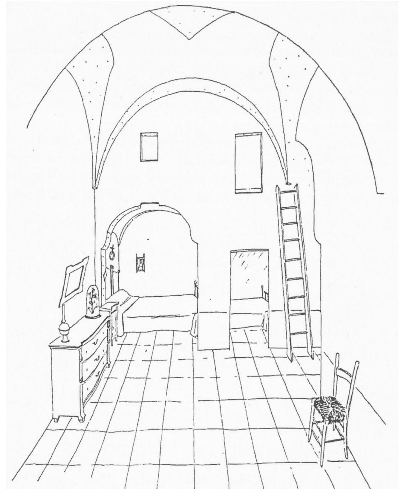
lizzate la volta a spigolo o leccese rappresentava la soluzione più diffusa. La sua forma deriva dall'intersezione tra una volta a crociera e una volta a bacinio, creando una superficie stellata su quattro unghie, viene infatti anche detta volta *a stella*. Questo modello costruttivo, ampiamente sperimentato dagli *artieri* fasanesi, migliorava la resistenza statica e consentiva una maggiore flessibilità nella disposizione degli ambienti.
