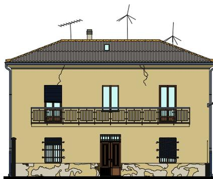
Fig. 39 - Prospetto sud del casello. Rilievo materico. Estratto della tavola 04\_Analisi materica e dei difetti.
