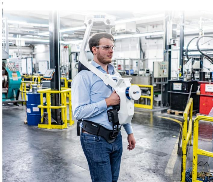
[Figura 30] Utente con indosso il dispositivo portatile NavVis VLX 2, impegnato nella scansione di un ambiente complesso. In NavVis. *NavVis VLX 2*. Consultato a Febbraio 2025 da <https://www.navvis.com/vlx-2>
