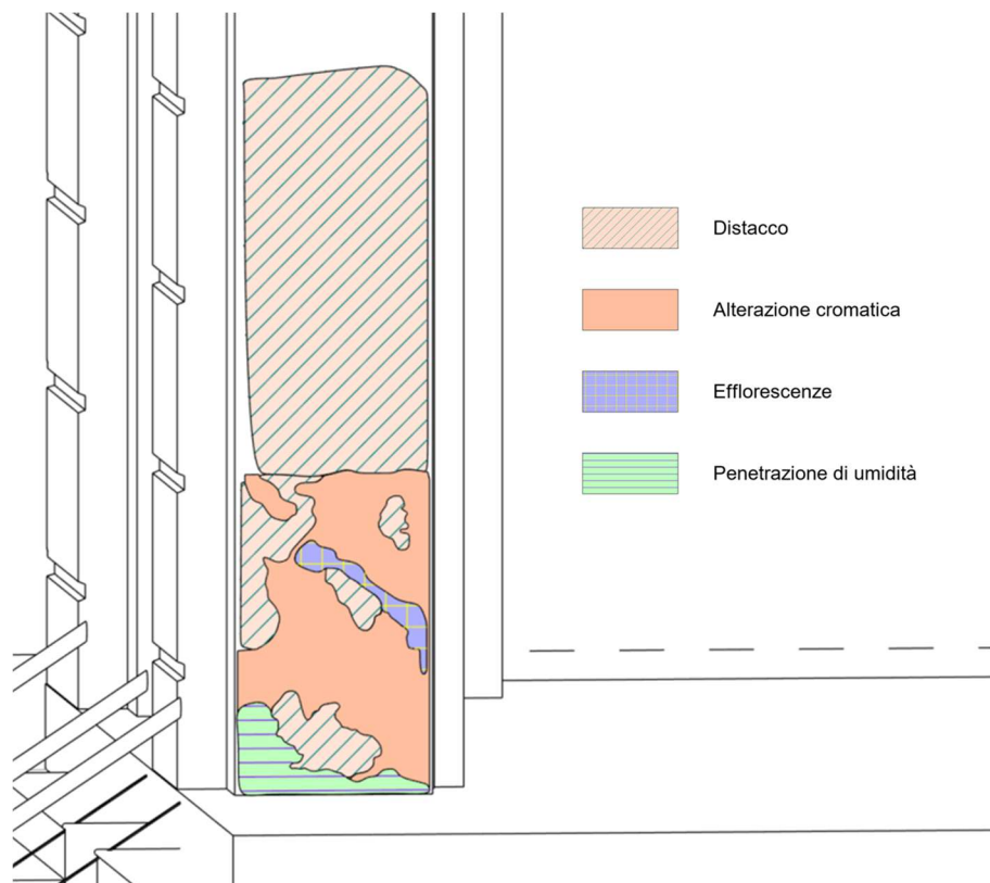
Figura 51 - Modellazione sul modello Revit delle anomalie riscontrate (Fonte: elaborato dall'autore)
