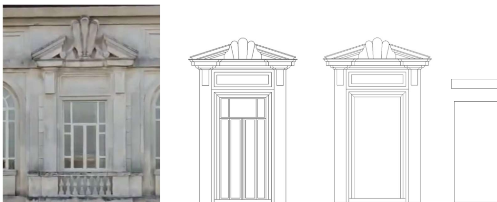
Figura 36 - Esempio di suddivisione degli elementi costitutivi l'infisso (Fonte: elaborato dall'autore)
