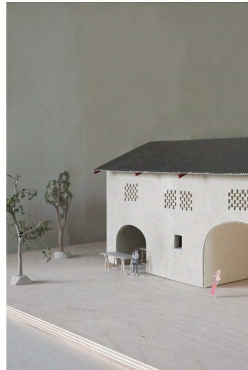
I portali metallici si inseriscono nell'involucro dell'antico fienile con un passo regolare scandito. Ogni coppia di pilastri si imposta agli angoli dello spazio destinato ai magazzini rimarcando la ripetitività della struttura originaria del fienile. I profilati utilizzati sono pensati per essere materiali riciclati o di recupero. La finitura è in antiruggine di colore rosso, stagliandosi dalla cromia tenue dell'antico.
