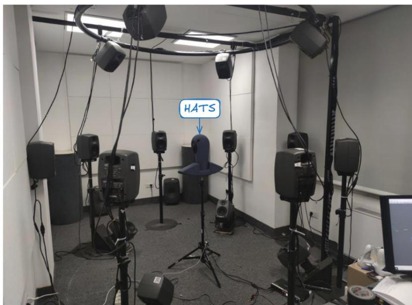
Figura 43: calibrazione della testa artificiale in Audio Space Lab
