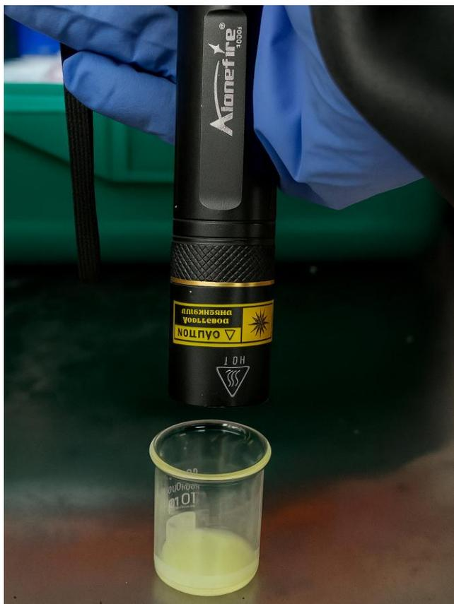
**Figura 19** - Prove preliminari di reticolazione effettuate con lampada UV portatile
