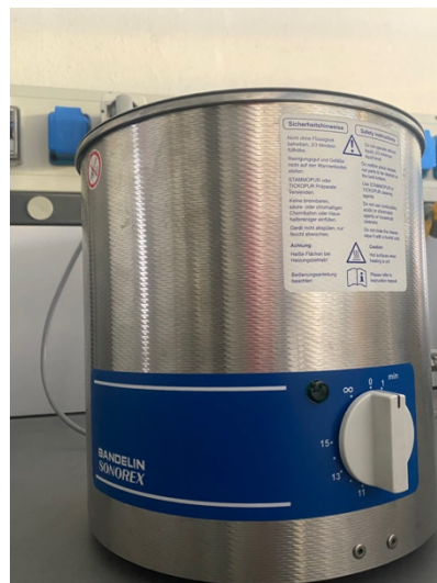
Figura 4.19. Bagni ad ultrasuoni per la pulizia di filtri (a sinistra) e di canister (a destra)
