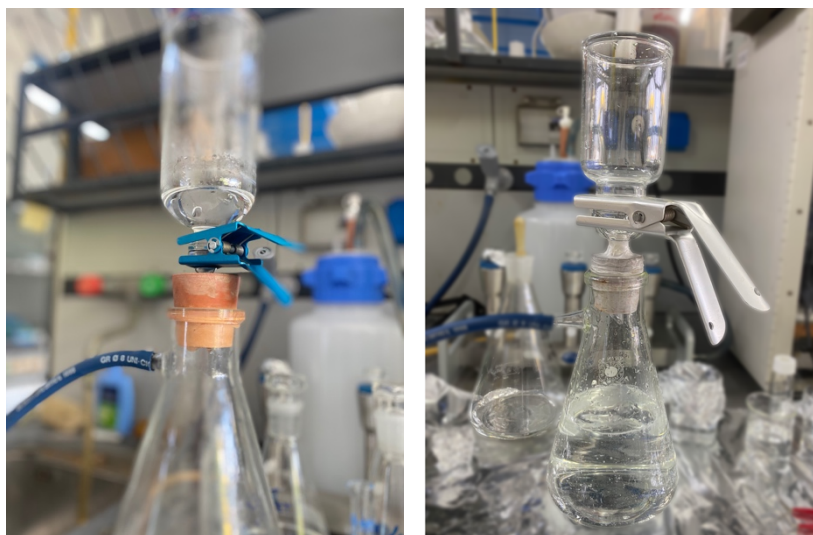
Figura 4.18. Apparato filtrante idoneo alla filtrazione mediante filtri di silicio (a sinistra) e mediante filtri in fibre di vetro (a destra)
