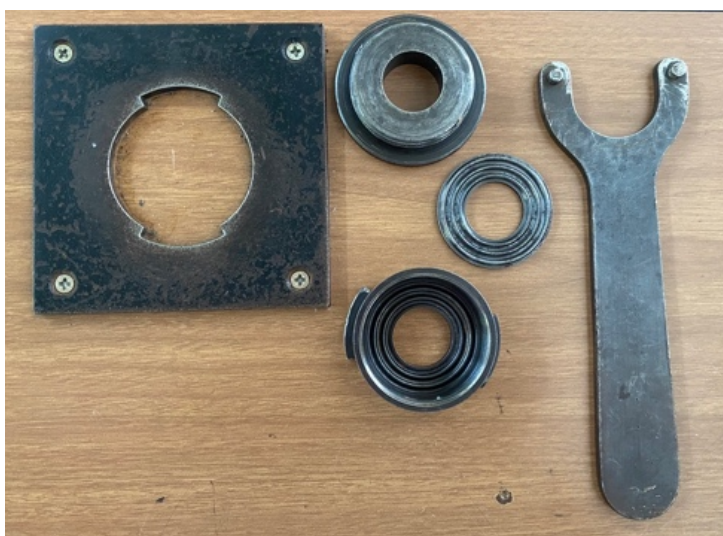
Figura 4.34. Portacampioni per le prove di perforazione dei tessuti
