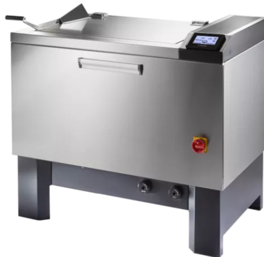
Figura 4.22. Gyrowash, apparecchio per le prove di lavaggio simulate
