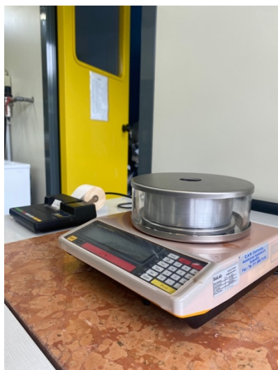
Figura 4.13. Bilancia e sistema di stampa per la misurazione della massa areica dei tessuti
