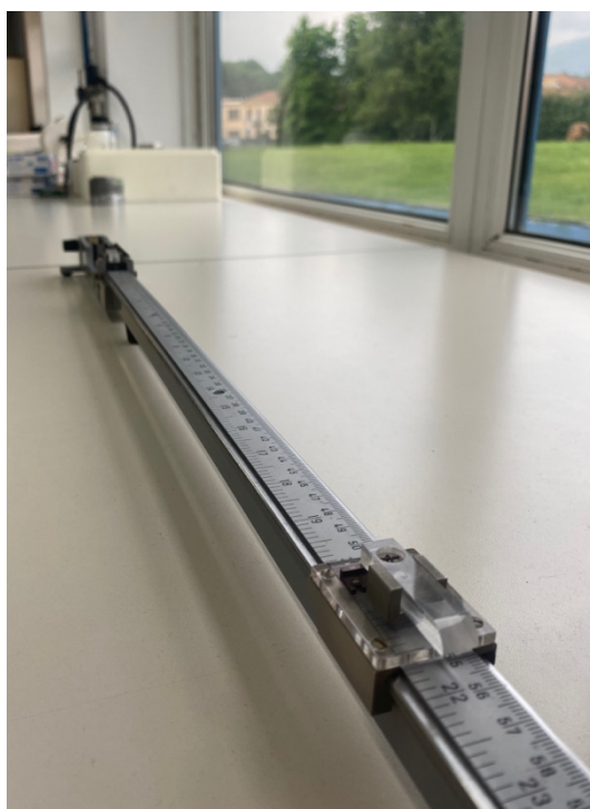
Figura 4.11. Strumento per la misura della lunghezza dei filati per la determinazione del titolo
