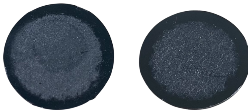
Figura 5.5. Filtri di silicio corrispondenti alla T-shirt non trattata al 1° (100 ml) (a sinistra) e al 3° lavaggio (100 ml) (a destra) caratterizzati da un film bianco superficiale
