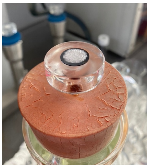
Figura 3.1. Tentativo di risospensione del materiale rilasciato da un campione tessuto raccolto su un filtro in fibre di vetro con conseguente filtrazione su un filtro in silicio
