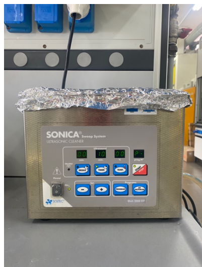
Figura 4.19. Bagni ad ultrasuoni per la pulizia di filtri (a sinistra) e di canister (a destra)
