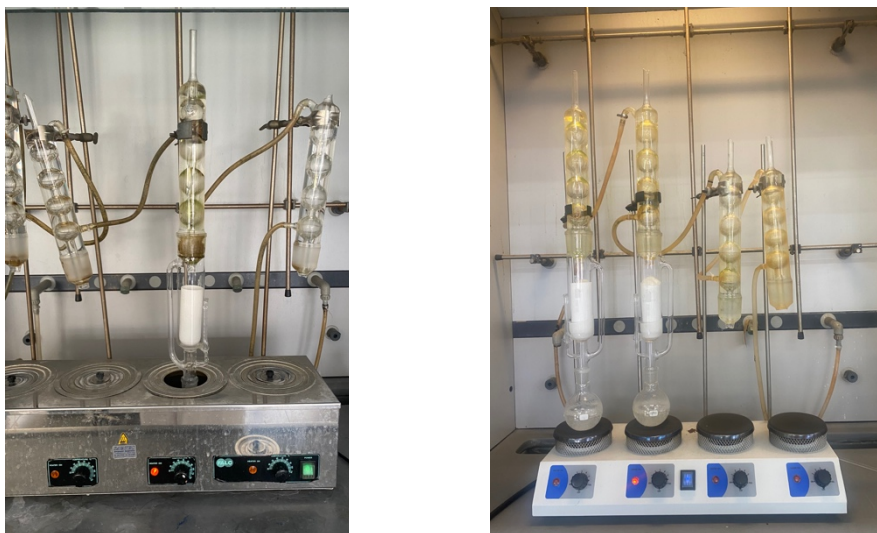
Figura 4.17. Sistemi di estrazione Soxhlet a bagnomaria (a sinistra) e con piastra riscaldante (a destra)
