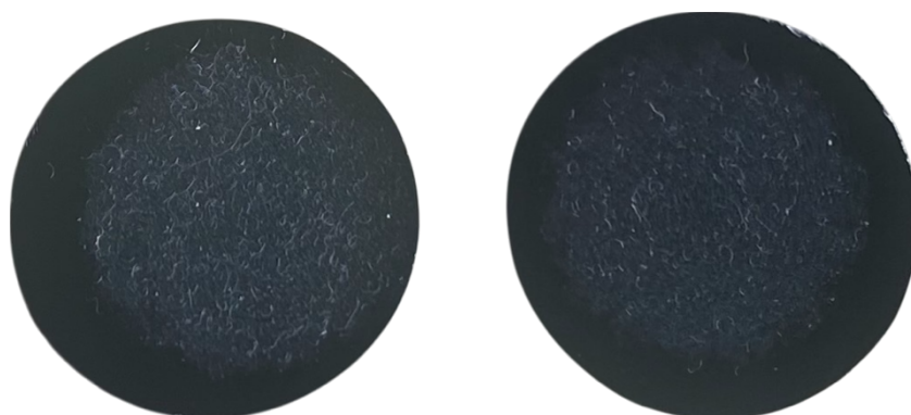
Figura 5.16. Filtri di silicio corrispondenti alla T-shirt sottoposta al processo di scouring al 1° (125 ml) (a sinistra) e al 3° lavaggio (125 ml) (a destra)
