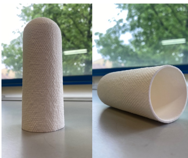
Figura 4.46. Ditale di cellulosa utilizzato per contenere il campione tessuto durante l'estrazione Soxhlet
