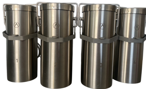
Figura 4.23. Canister: contenitori in acciaio inox per campioni tessili sottoposti alle simulazioni di lavaggio
