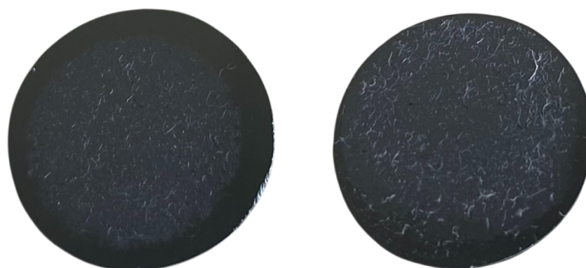
Figura 5.29. Filtri di silicio corrispondenti alla felpa sottoposta al processo di doppia estrazione al 1° (20 ml) (a sinistra) e al 3° lavaggio (50 ml) (a destra)
