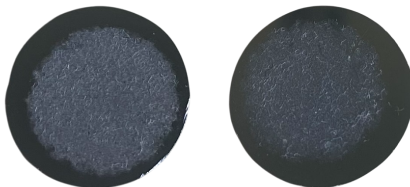
Figura 5.17. Filtri di silicio corrispondenti alla T-shirt sottoposta al processo di doppia estrazione al 1° (125 ml) (a sinistra) e al 3° lavaggio (125 ml) (a destra)
