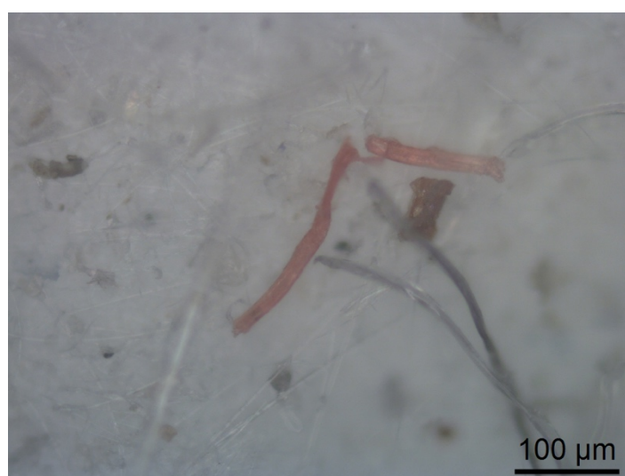
Figura 4.36. Esempio di contaminazione sintetica estranea al campione di T-shirt, rilevata durante la prova gravimetrica su filtro in fibre di vetro
