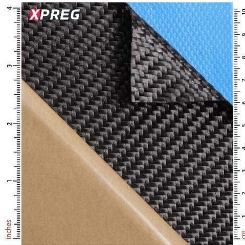
**Figura 2.1:** *prepreg* XPREG® XC110 in fibra di carbonio 6k con trama *twill 2x2* <sup>(10)</sup>
