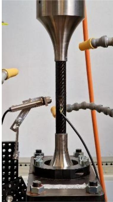
**Figura 3.11:** configurazione sperimentale per prove VHCF con estensimetria
