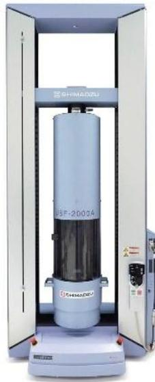
**Figura 1.8:** macchina per prove di fatica ad alta frequenza utilizzata nei test VHCF <sup>(8)</sup>
