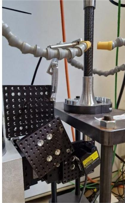
**Figura 3.8:** dettaglio del sistema di raffreddamento e sensore IR in zona provino
