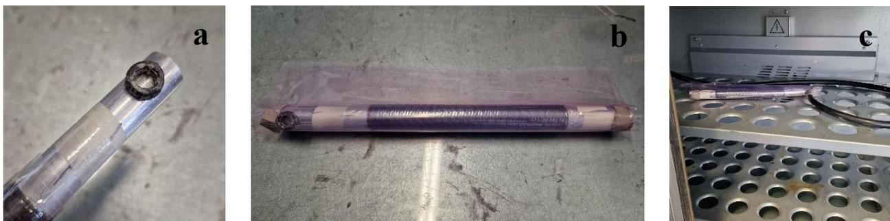
**Figura 2.12:** (a) installazione della valvola per effettuare il vuoto, (b) applicazione del *sealant tape* e della *bag*, (c) posizionamento del provino nel forno
