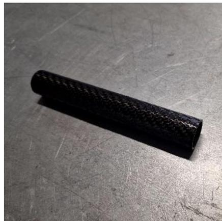
**Figura 2.14:** provino tubolare rifinito pronto per effettuare i test VHCF
