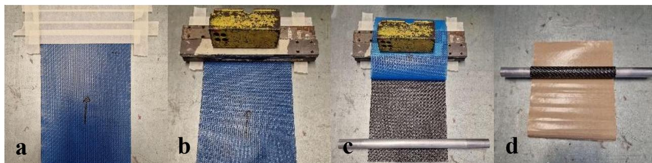
**Figura 2.10:** (a) incollaggio di un'estremità del tessuto tramite nastro carta, (b) applicazione dei pesi sulla medesima estremità, (c) inizio fase di avvolgimento del *prepreg*, (d) fine fase di avvolgimento
