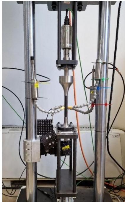
Figura 3.5: macchina per prove VHCF in configurazione assiale
