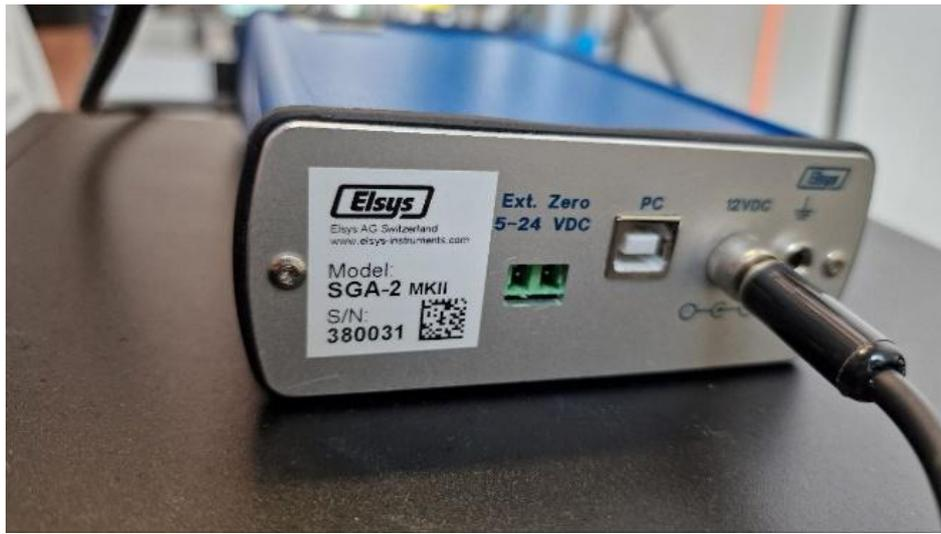
**Figura 3.10:** amplificatore di segnale Elsys SGA-2 MKII utilizzato per l'estensimetria
