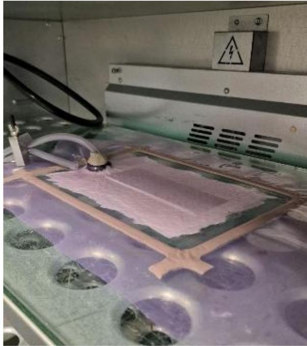
**Figura 2.5:** complesso posto all'interno del forno pronto ad effettuare il ciclo di cura
