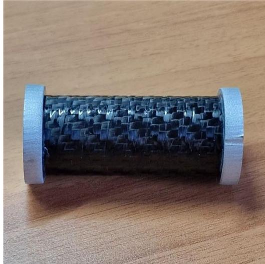
**Figura 6.2:** campione reale in fibra di carbonio con dischi metallici terminali
