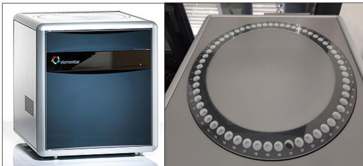
Figura 23. Analizzatore elementare, CHNS: Elementar, Vario EL Cube. 66
