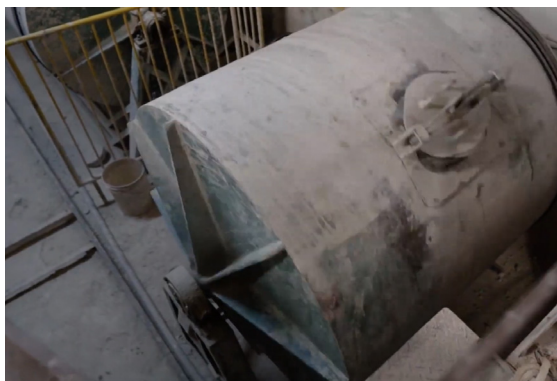
(Fig. 94) Impastatrice a tamburo utilizzata per la produzione della miscela ceramica.
