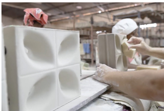
(Fig. 98) Fase di esponja per la rifinitura delle linee di giunzione.
