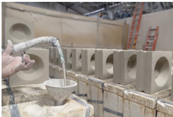
(Fig. 96) Colata della miscela in stampi di gesso idrato con l'aiuto di un imbuto.
