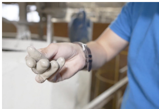
(Fig. 95) Dimostrazione tattile della finezza della grana nella miscela ottenuta.
