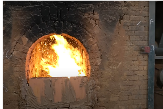
(Fig. 82) Forno garrafão , alimentato a legna di scarto.
