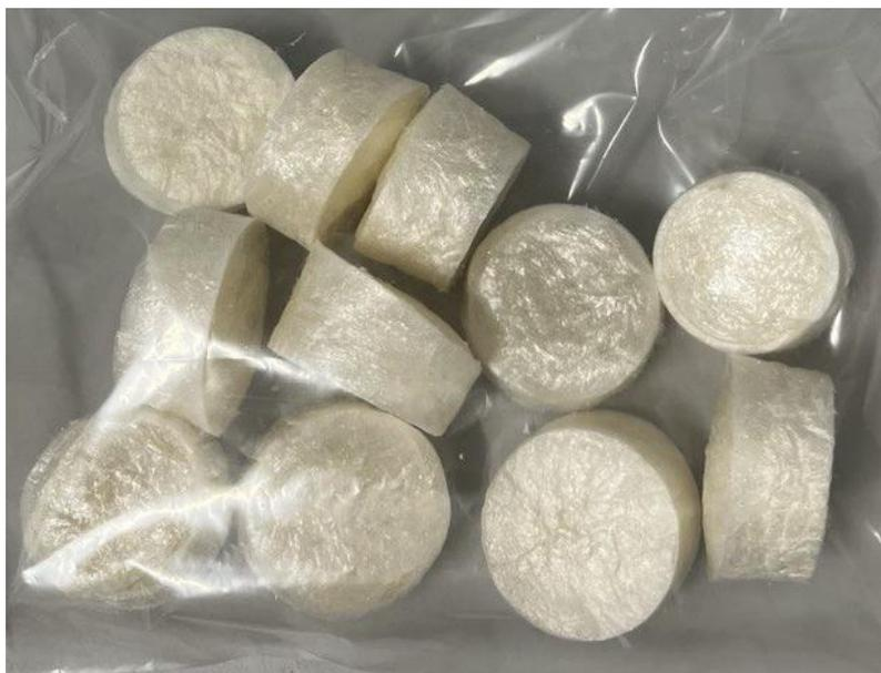
*Figura 2.2: GelMA liofilizzata. Fonte propria.*
