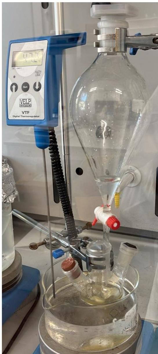
*Figura 2.4: Set up sperimentale per la sintesi della GelMA-COOH. Fonte propria.*
