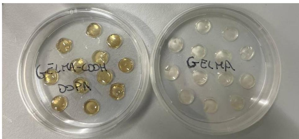
Figura 2.15: Campioni di GelMA e GelMA-COOH-DOPA utilizzati per le prove di mezzo condizionato. Fonte propria.
