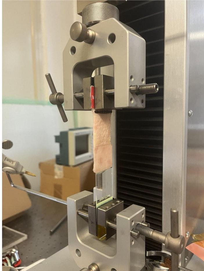
*Figura 2.14: posizionamento del campione all'interno della macchina a trazione. Fonte propria.*
