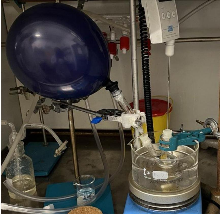
*Figura 2.6: Set up sperimentale per la sintesi della GelMA-COOH-DOPA. Fonte propria.*
