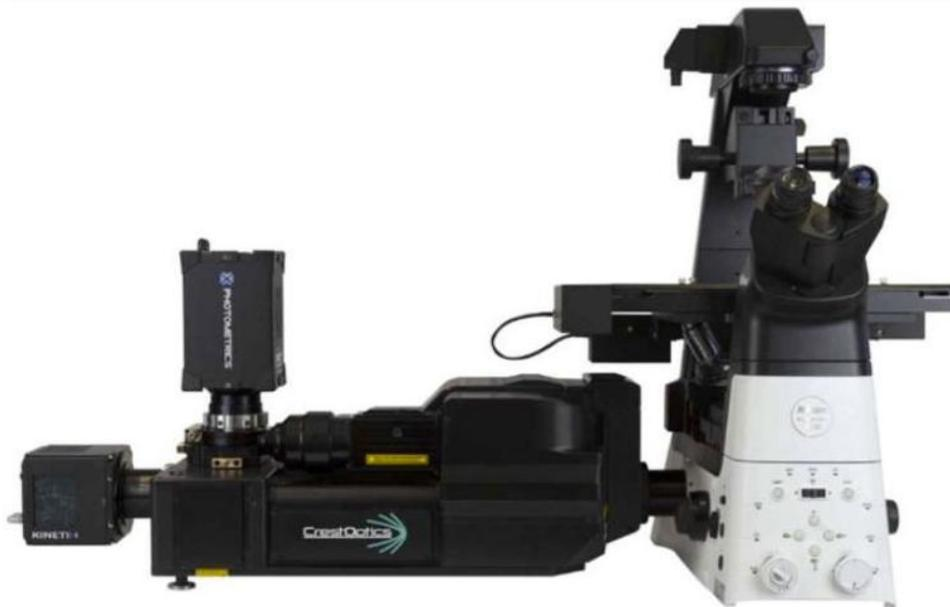
Figura 2.19: microscopio Nikon Eclipse Ti2 dotato di sistema confocale a disco rotante (spinning disk) Crest X-Light.
