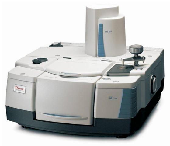
Figura 2.7: FT-IR Nicolet iS50 in modalità ATR. Fonte: <https://www.thermofisher.com>
