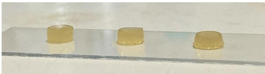
Figura 2.12: Campioni di GelMA-COOH-DOPA ottenuti tramite protocollo di fotopolimerizzazione descritto. Fonte propria.
