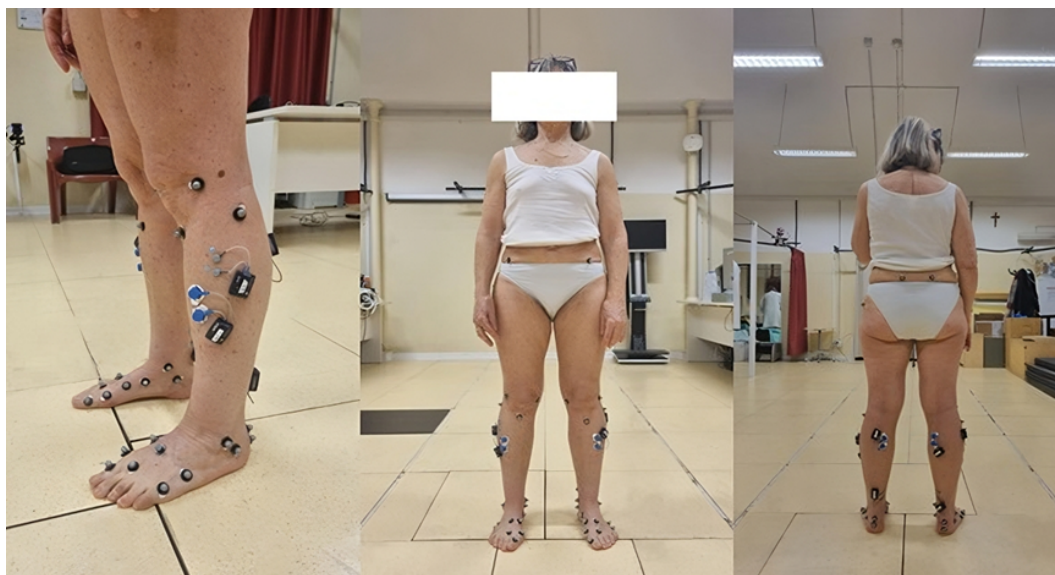
Figura 2.3: Posizionamento dei marker e degli elettrodi di superficie.
