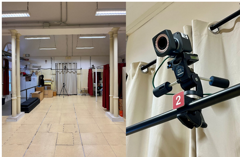
Figura 2.1: A sinistra, il Laboratorio di gait analysis con sistema stereofotogrammetrico e, a destra, una telecamera del sistema Vicon.
