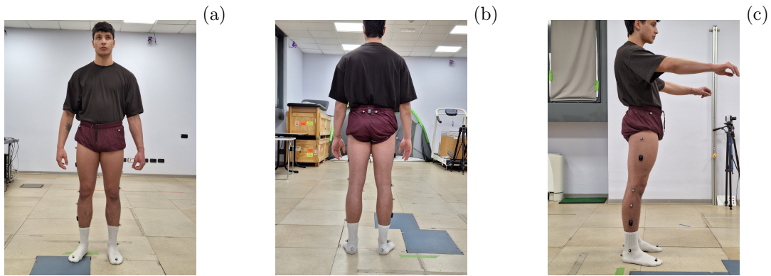
Figura 5.3. Vista frontale (a), posteriore (b) e laterale (c) dei sensori posizionati sul soggetto.
