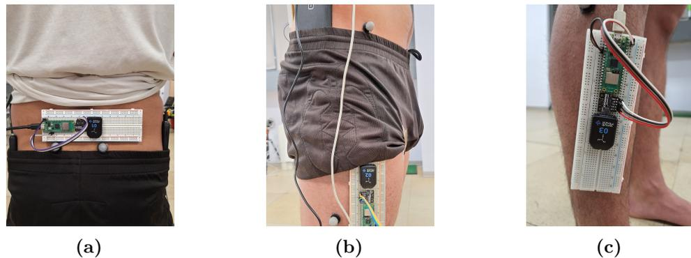
**Figura 6.2:** L'immagine mostra il dettaglio del posizionamento dei sensori inerziali di brain Technologies e WaveTrack (Cometa, Italia) sul corpo del soggetto: (a) pelvi, (b) coscia, (c) gamba.
