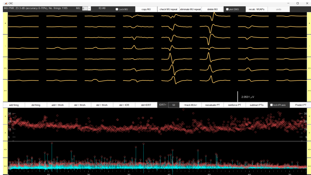
Figura 3.11: CKC Inspector: in alto si osservano i MUAPs dei 64 canali mediati tramite STA, in basso si hanno: il firing pattern con i relativi Instantaneous Discharge Rates (IDR) per ogni sparo, i treni dei pulses, relativi anch'essi a ciascun evento (subj #4 – presa 30 mm – MU #6).
