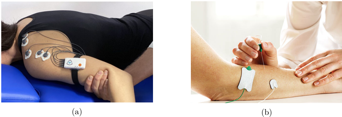
Figura 2.14: Modalità di acquisizione del segnale elettromiografico: (a) sEMG, (b) iEMG
