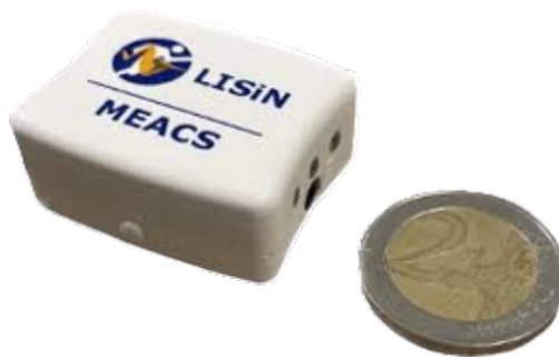
Figura 3.3: Sonda MEACS confrontata dimensionalmente con una moneta da 2 euro.
