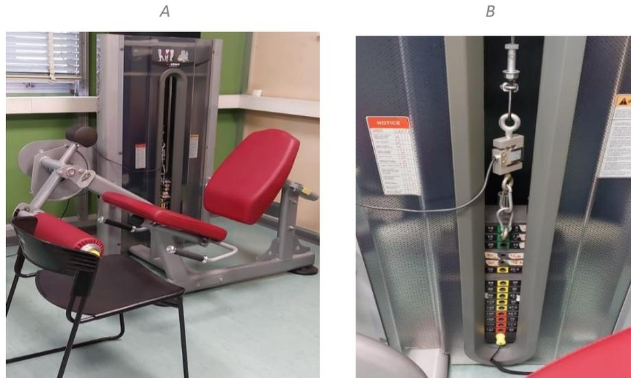
Figure 2.4: setup sedia sensorizzata presso l'ospedale di parma a) BH L010 leg extension, b) cella di carico
