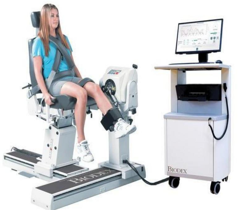
*Figura 2.5: Biodex System 4 pro usato per estensione della gamba*
