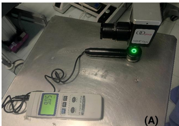
Figura 3.18: (A) Misurazione della capacità di emissione della testa ottica con UV Light Meter. (B) Processo visualizzato sul monitor del dispositivo CSO VEGA CBM X-LINKER.
