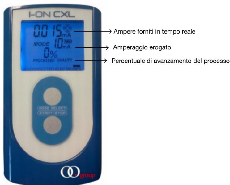
Figura 3.15: Generatore I- ON CXL [82].
