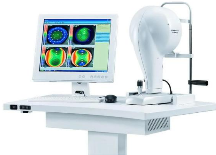
Figura 4.5: Topografo CSO Sirius e visuale delle mappe colorimetriche [91].
