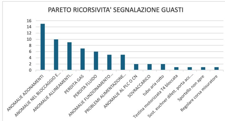
Figura 5.2. Analisi di Pareto in base alla ricorsività per tipologia di segnalazione guasto FAMAR 1
