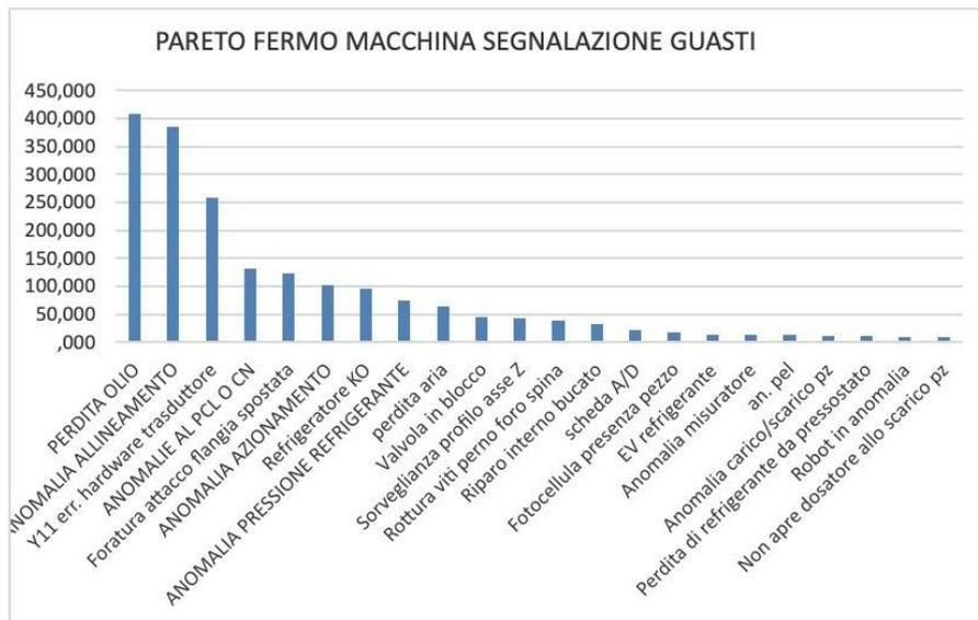
Figura 5.5. Analisi di Pareto in base al tempo fermo macchina per tipologia di segnalazione guasto FAMAR 2
