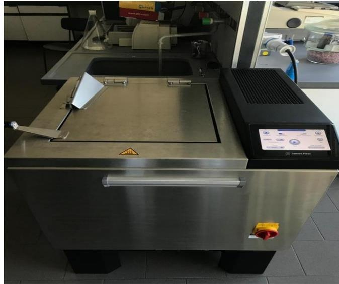
**Figura 4.9:** Linitest modello James Heal utilizzato per testare la solidità al lavaggio secondo la norma UNI-EN-ISO 10-C06
