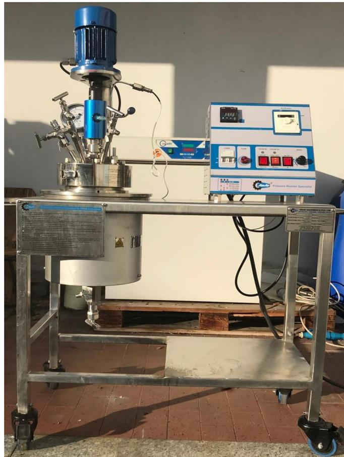
**Figura 3.3:** Autoclave a pressione da 5 litri con agitazione meccanica, Amar Equipment
