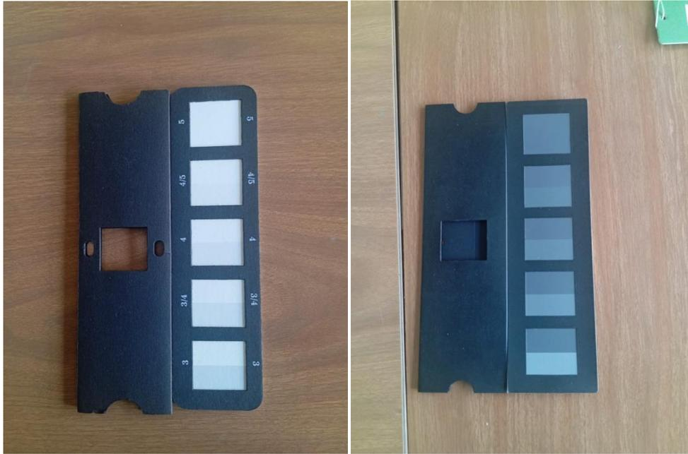
**Figura 4.12:** Scala dei grigi scura (a destra), chiara (a sinistra) utilizzate per le solidità al lavaggio
