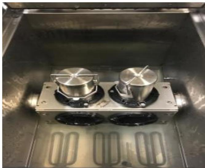
**Figura 4.10:** Cestello rotante all'interno del Linitest
