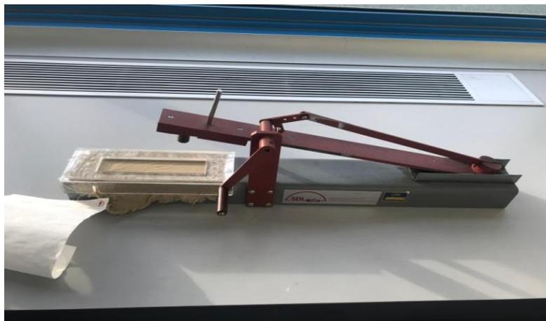
**Figura 4.13:** Immagine del Crockmeter
