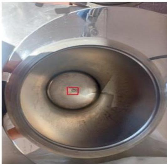
**Figura 3.4:** Valvola di chiusura e di recupero dell'idrolizzato sul fondo dell'autoclave
