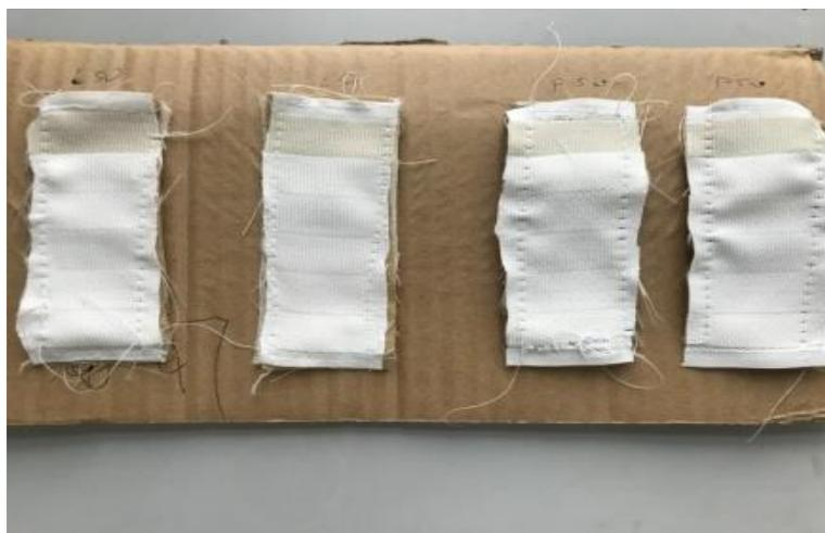
**Figura 4.8:** Assemblaggio di campioni tinti, standard e multi fibra
