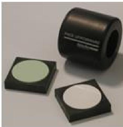
**Figura A.9:** Strumenti per la calibrazione del Datacolor Spectroflash SF 600X [74]
