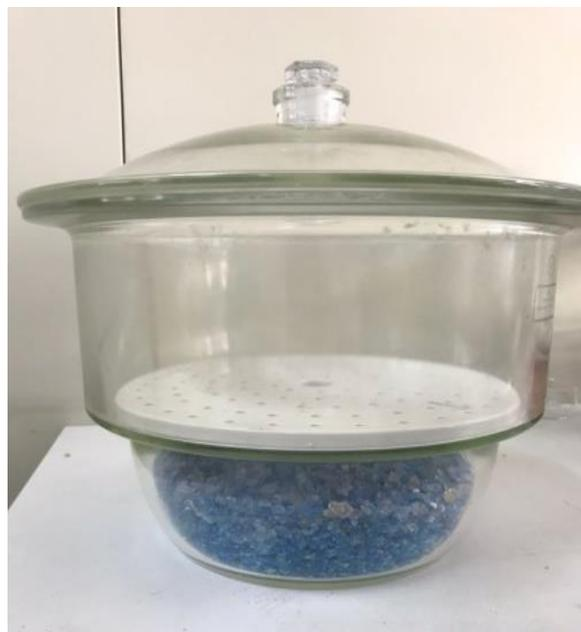
**Figura 3.1:** Campana essiccante con gel di silice
