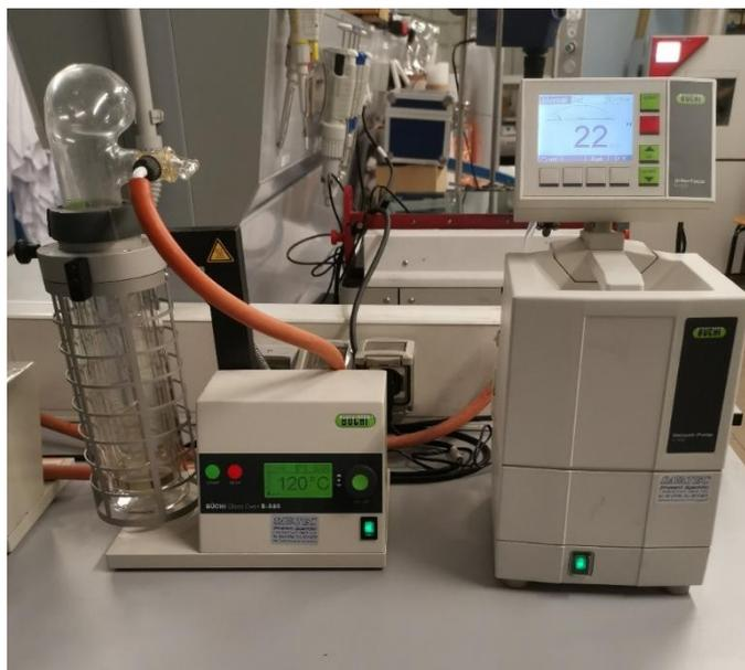
**Figura 4.2-3** Pompa a vuoto e fornello riscaldante per essiccazione elettrodi
