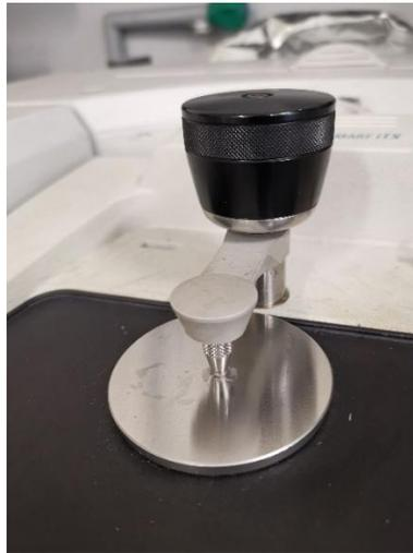
**Figura 4.4-2** Setup dello strumento per la misura ATR
