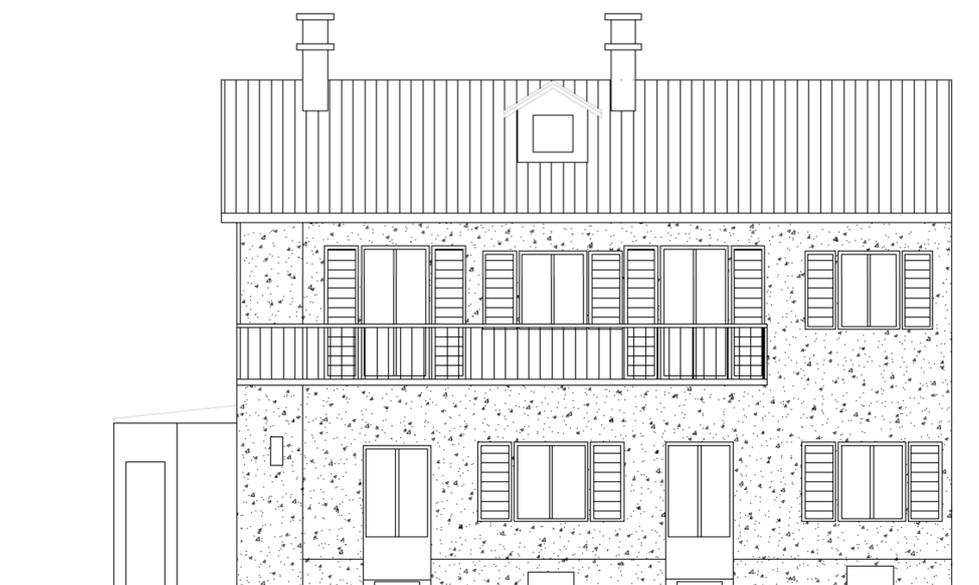
*Figura 47: Prospetto su Via Aosta con Intonaco armato*
