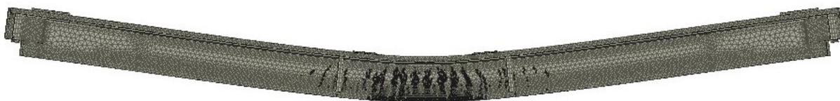
**Figura 4-8.** Confronto tra le deformate nello step di massima freccia a) della trave reale b) del modello numerico non lineare agli elementi finiti.
