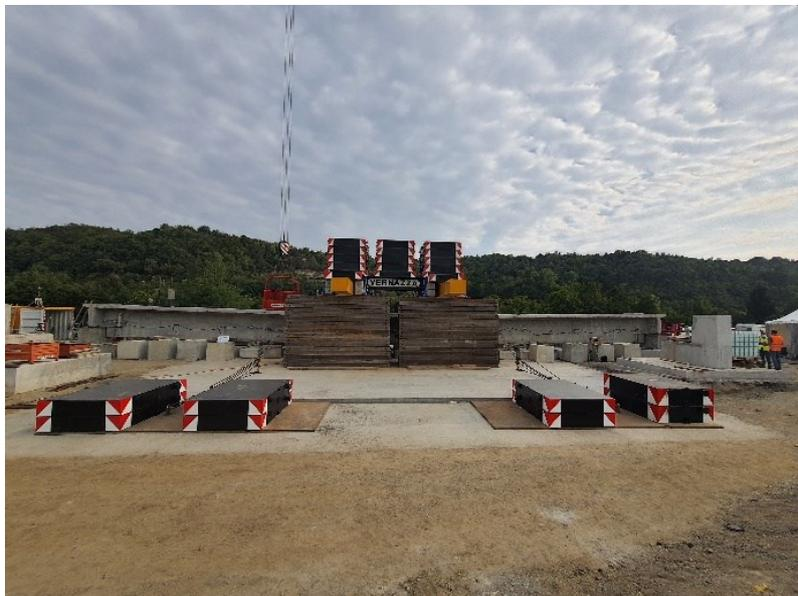
**Figura 2-17.** Immagine della trave durante la prova sperimentale sotto massimo carico, da documentazione fotografica di prova.
