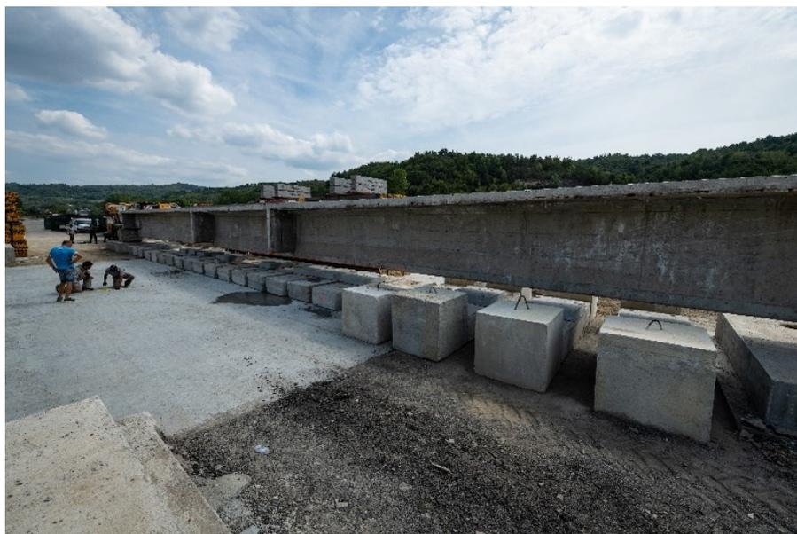
**Figura 2-11.** Vista della trave di luce 34.6 m durante la preparazione della prova di carico, da documentazione fotografica della prova.
