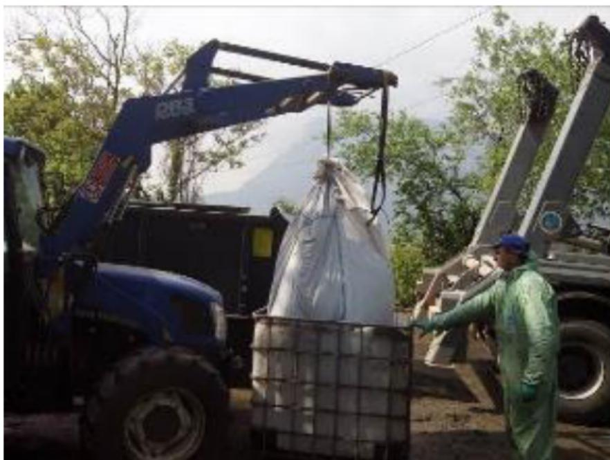
**Figura 2.4:** Operazione di riempimento cenere con dei *big bag* [17]
