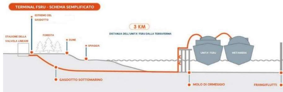
Figura 1: Schema qualitativo del progetto Terminal FSRU [23].
