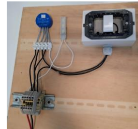
Figura 7. Schema elettrico di montaggio per l'accensione luce con Shelly 1 V3
