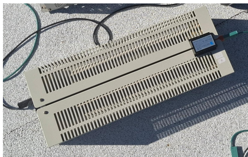
Figura 2.6. Resistenza variabile con cursore METREL da 500 \Omega
