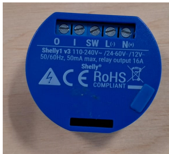
Figura 6.9. Dispositivo Shelly 1 V3 relè WIFI intelligente
