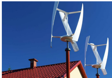
Figura 1.20. Aerogeneratore eolico ad asse verticale [4]
