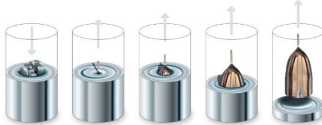
Figura 1.8. processo di Czochralski [51].
