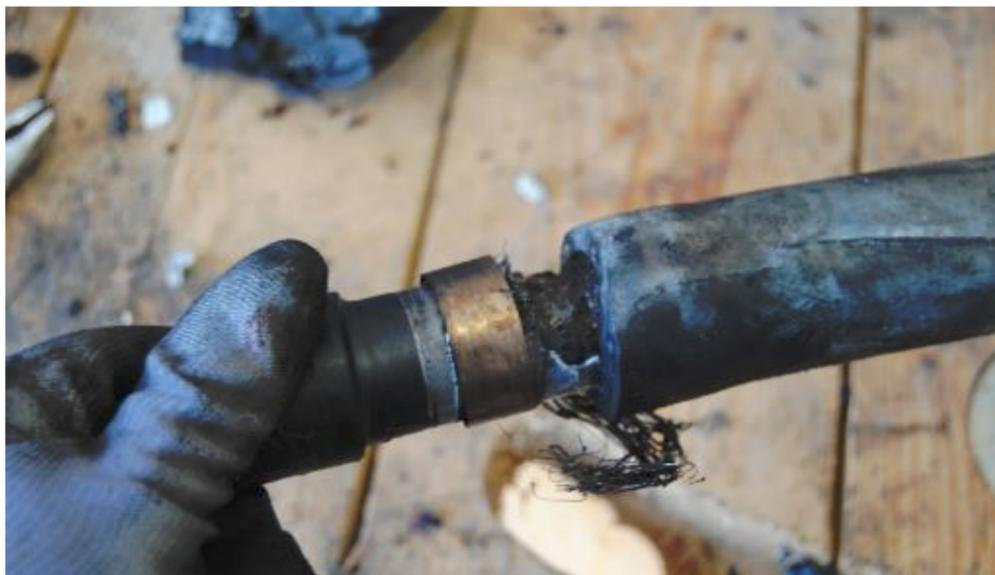
**Figura 2.1:** Collegamento danneggiato tra lo schermo del cavo e lo schermo del giunto. - A.Sturchio et al., «*Thermal behavior of distribution MV underground cables*»[12]
