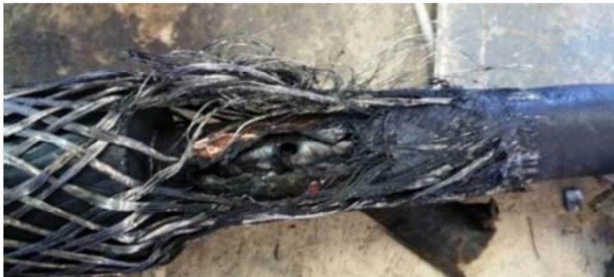
**Figura 1.8:** Ispezione del giunto di un cavo interrato dopo il cedimento. - *L. Calcara et al.*, «*Faults Evaluation of MV Underground Cable Joints*»[9]
