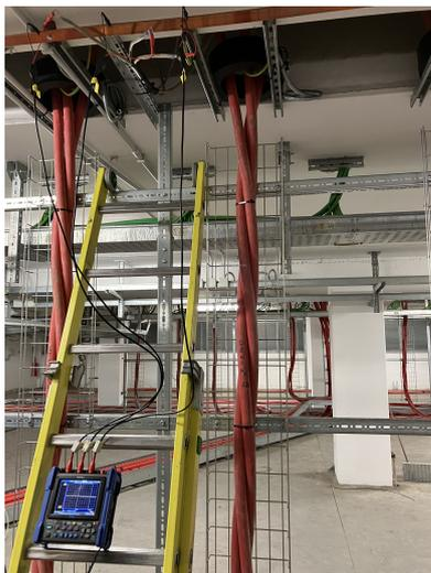
Figura 3.6: Acquisizione delle tensioni sugli schermi
