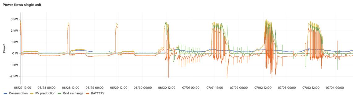
Figura 3.5: Andamento temporale della produzione, del consumo e dello stato di carica per la singola unità selezionata.
