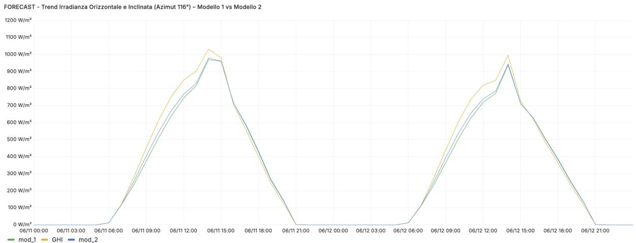
Figura 5.8: Confronto irradianza inclinata mod\_1 e mod\_2 con GHI – Azimut 116°, giorni 5–6 maggio.
