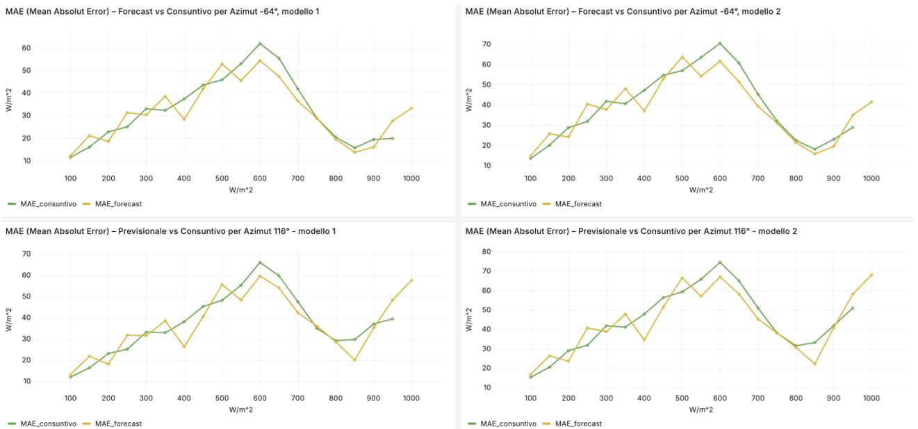
Figura 7.2: MAE (Mean Absolute Error) per azimut  $-64^\circ$  e  $116^\circ$  nei modelli 1 e 2, a confronto tra consuntivo (verde) e forecast (giallo).
