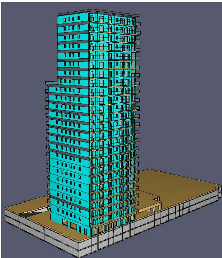
Figura 17 Soluzione difforme RTV13 per materiale (EPS) vista Sud-Ovest
