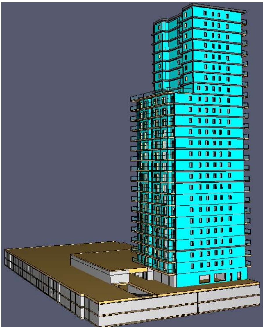
Figura 20 Soluzione difforme RTV13 per materiale (EPS) con utilizzo di marcapiano vista Nord-Ovest
