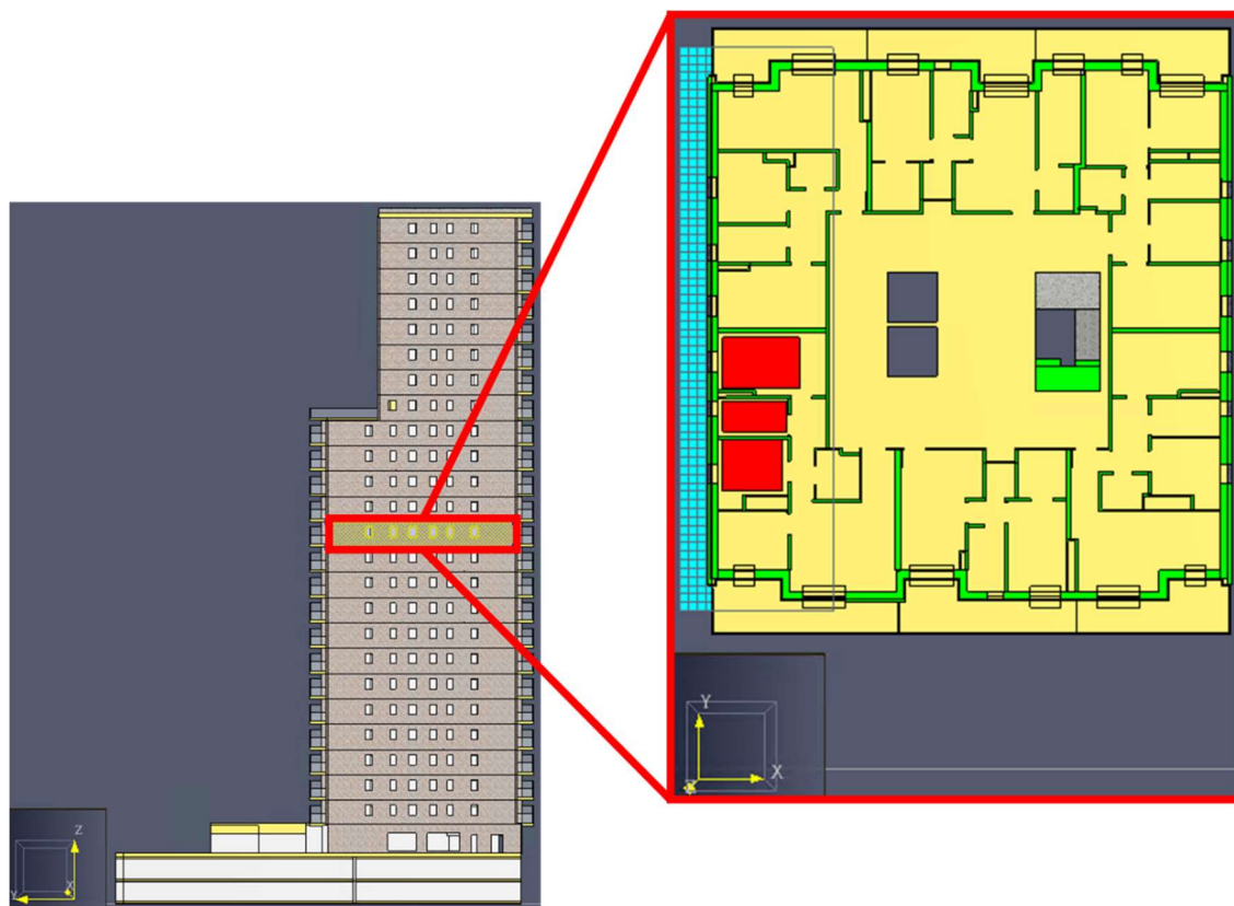
Figura 47 Vista in prospettiva e in pianta del posizionamento del focolare
