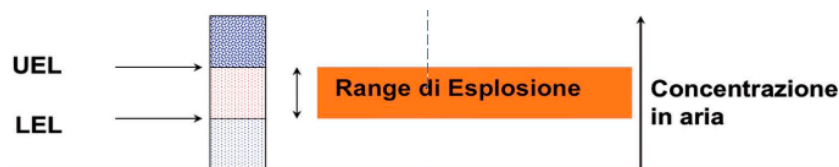
Figura 20. Range di esplosione e livelli di esplosività [8]
