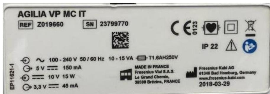
*Fig. 41: dati di targa pompa di infusione Fresenius mod. Agilia VP MC IT*
