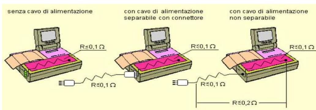
Fig. 43: valori di resistenza sistema di messa a terra di protezione
