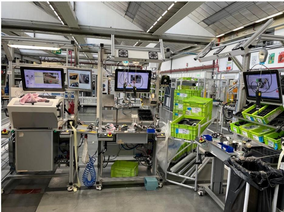
*Figura 36: Esempio di una linea Valeo a tre stazioni*
