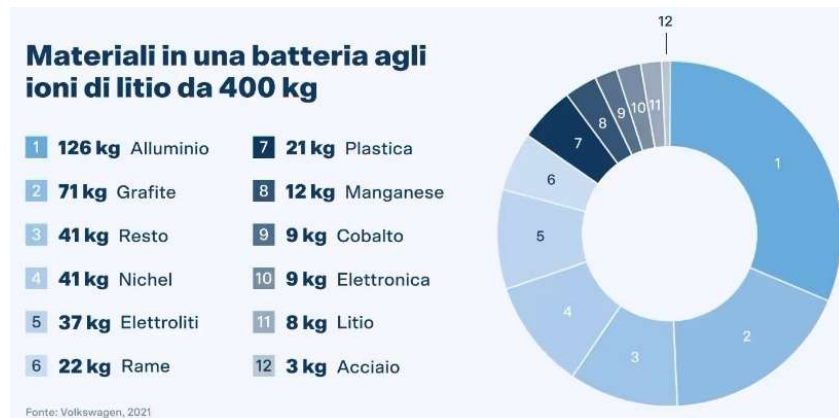
Figura 17: Peso di ogni materiale in un pacco batterie
